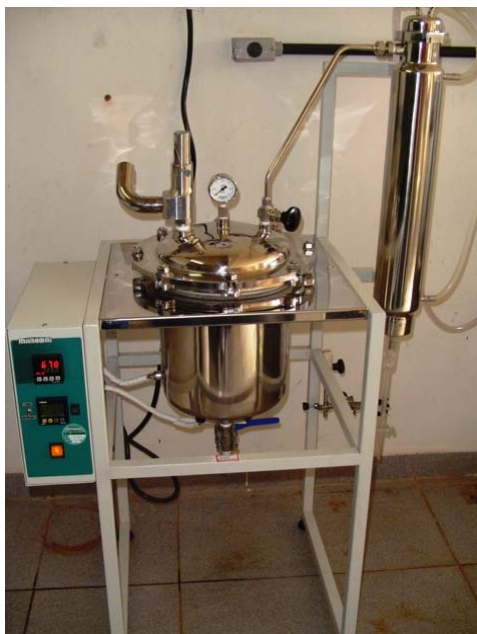
Figura 7 - Esquema do destilador por arraste a vapor d'água
