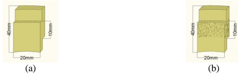
Figura 42 – Corpos de prova internodal (a) e nodal (b) para determinação da resistência ao cisalhamento tangencial do bambu
