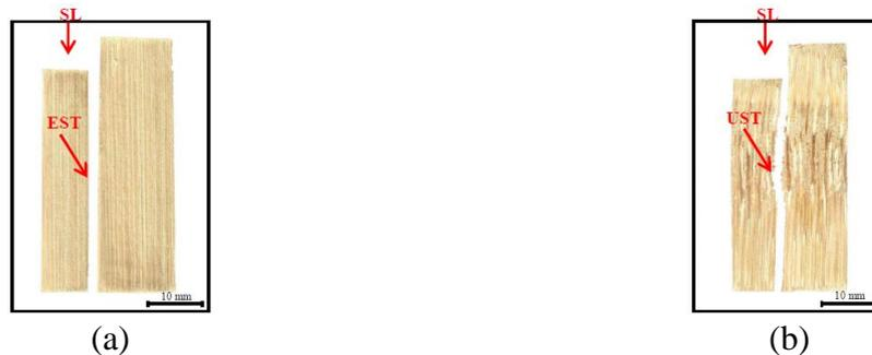
Figura 23 – Tipos de rupturas provocadas pelo ensaio de resistência ao cisalhamento radial em lâminas internodais (a) e com nó na área de cisalhamento (b)
