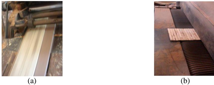
Figura 61 – Ajuste das espessuras de um dos painéis do tipo  $PBLC_{0^\circ}$  na plaina desempenadeira (a) e de um dos painéis do tipo  $PBLC_{90^\circ}$  na lixadeira desgrossadeira (b)
