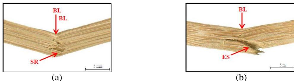
Figura 20 – Modos de ruptura das lâminas de bambu da região internodal (a) e da região nodal, onde BL indica o ponto de aplicação da carga, SR fissuras padrão da tração e ES cisalhamento extensivo.
