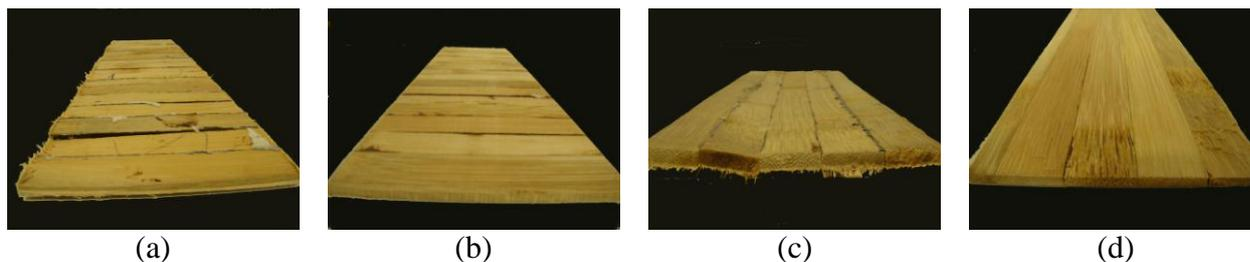
Figura 164 – Painéis individuais de  $BLC_{90^\circ}$  sem plainar (a) e plainado (b) e painéis de  $BLC_{0^\circ}$  sem plainar (c) e plainado (d)
