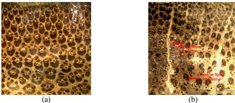
Figura 69 – Arranjo anatômico da região internodal (a) e nodal (b) da ripa de bambu
