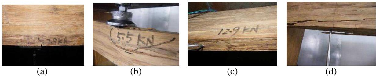
Figura 26 – Ruptura frágil (a), por compressão (b), estratificada (c) e oblíqua (d)
