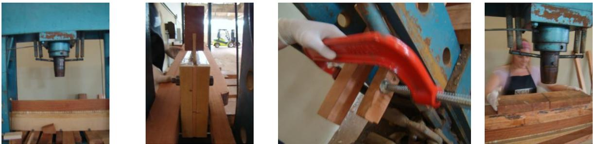
Figura 55 – Posicionamento da fôrma na prensa (a), fôrma com a peça de distribuição de pressão e barras de madeira (b) para travamento da fôrma com grampo de marceneiro (c) e posicionamento da 2ª peça utilizada para distribuição uniforme da pressão na prensagem de um painel 0°
