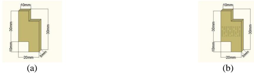
Figura 41 – Corpos de prova para o ensaio de resistência ao cisalhamento das lâminas internodais (a) e nodais (b)
