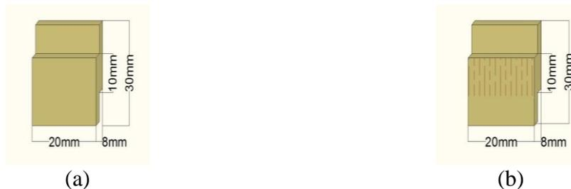
Figura 43 – Dimensionamento dos corpos de prova sem nó (a) e com nó (b) da lâmina para determinação da resistência ao cisalhamento tangencial do bambu
