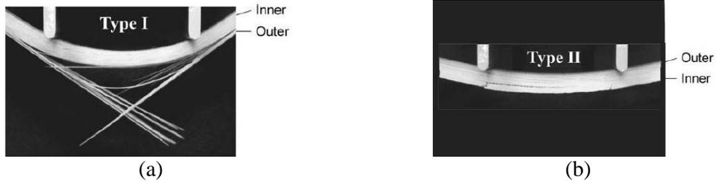
Figura 17 – Modos de ruptura de ripas de bambu de acordo com os tipos I (a) e II (b)
