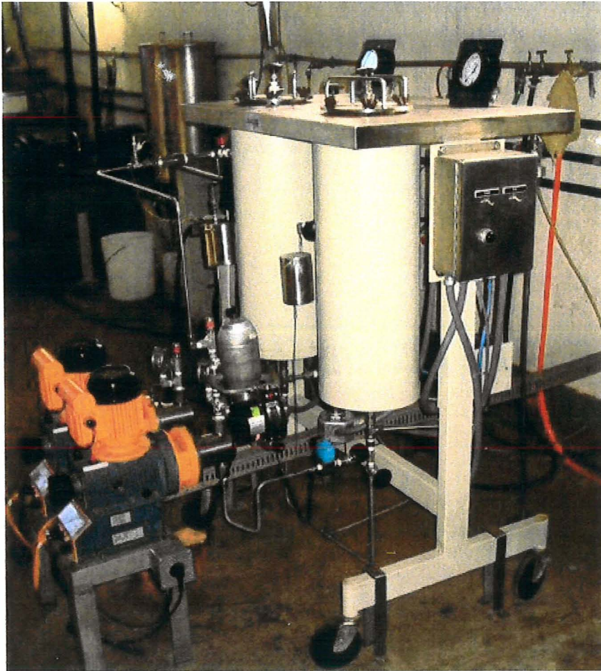
Figura 3 – Digestor laboratorial M/K adaptado para cozimentos modificados
