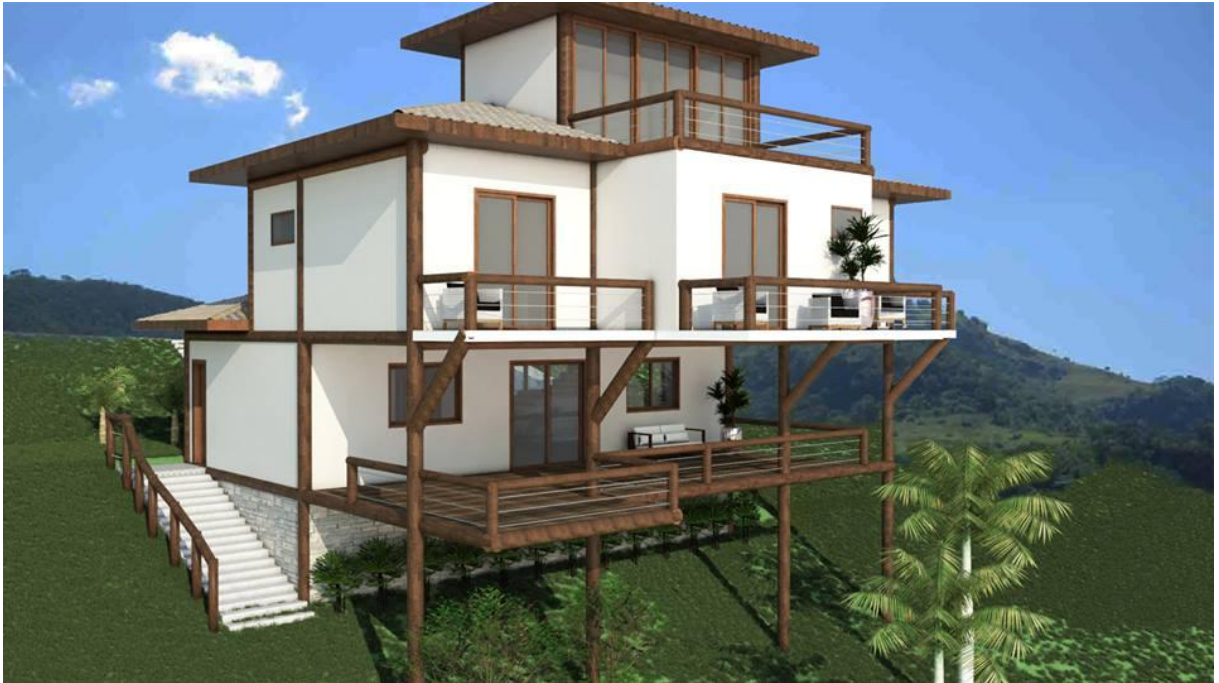
Figura 15: Casa de paliteiro com alvenaria. Fonte: Scali & Mendes (2016).
