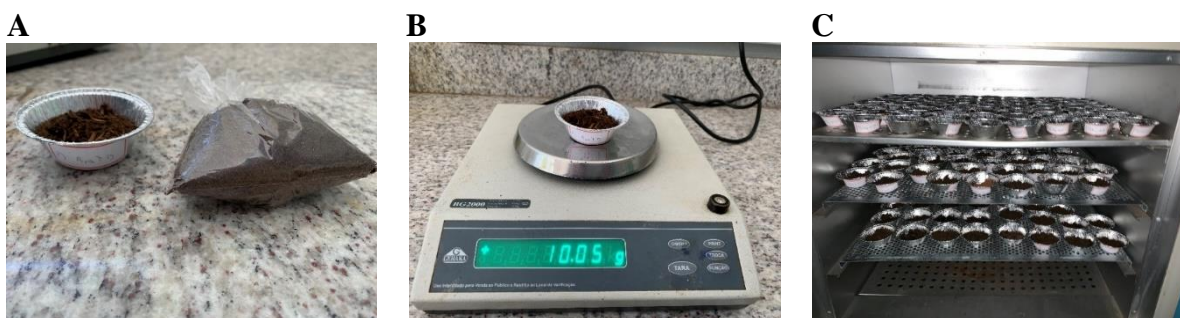
Figura 8. Amostra da cama armazenada em sacola plástica e colocada em recipiente de alumínio devidamente identificado (A); amostra sendo pesada em uma balança de precisão (B); amostras sendo colocadas na estufa para a secagem (C)
