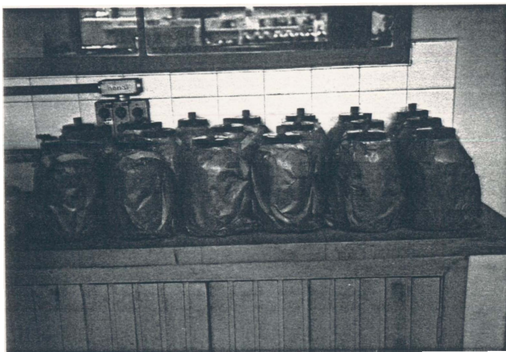
Foto 4. Aspecto dos frascos de vidro de 3 litros usados na incubação das raízes de arroz para o teste de ARA.
