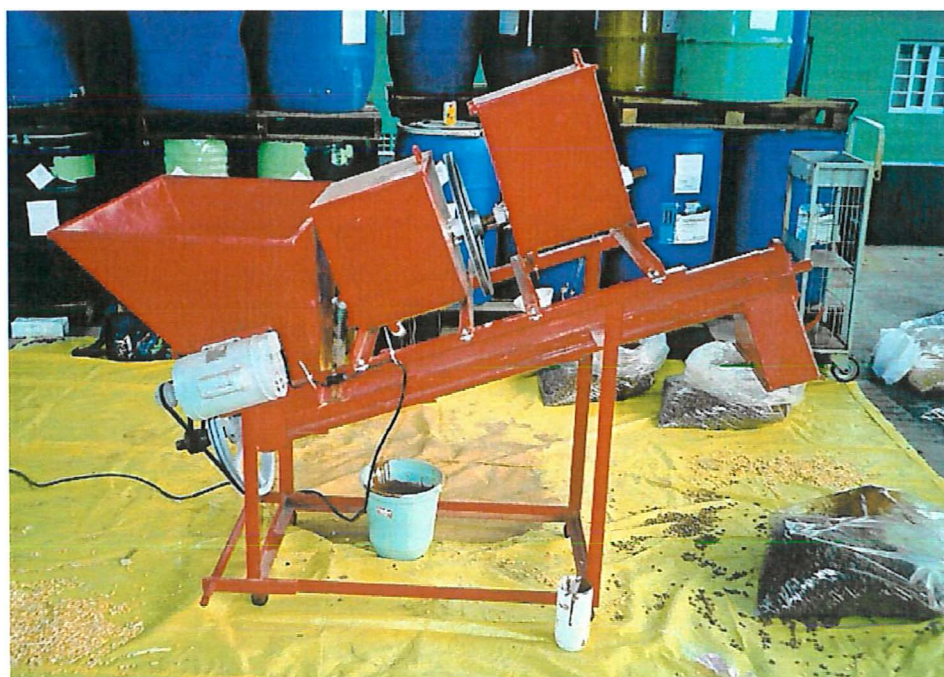
Figura 14 – Máquina de tratamento de sementes em escala industrial, utilizada para experimento de sementes camufladas. No piso, em sacos plásticos, resultados de três testes de camuflagem, variando concentrações de Carbofuran, corante em pó, adesivo e água
