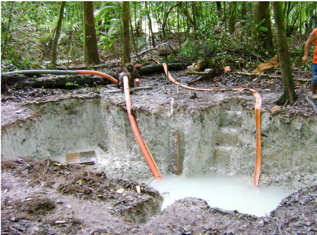
Figura 19. Área cavada pelo uso dos jatos para retirada de ouro.
