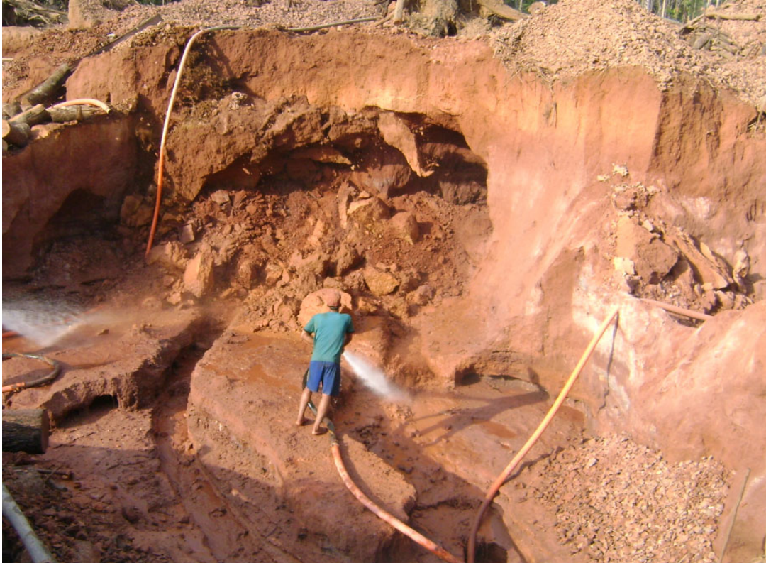
Figura 18. Jato de água em barranco escavado para a lavagem da terra.
