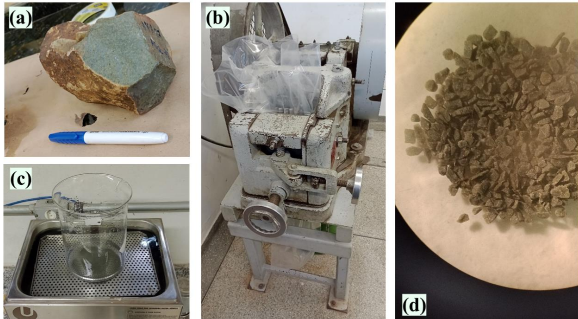
Figura 4.1 – (a) Bloco da amostra ARI28 (hornfels). (b) Triturador de rochas do LAGIS-IG-UNICAMP. (c) Banho ultrassônico das amostras moídas. Procedimento realizado no CPGeo-IGc-USP. (d) Imagem de lupa dos grãos selecionados para datação ( \pm 1 mm). Fonte: autoria própria.
