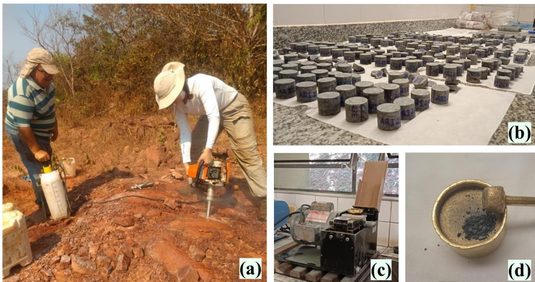
Figura 5.1 – (a) Amostragem paleomagnética, com auxílio da perfuratriz adaptada com broca diamantada. (b) Espécimes de diabásio na bancada do laboratório. (c) Serra-dupla manual do USPMAG. (d) Espécime triturado no almofariz de latão. Fonte: autoria própria.
