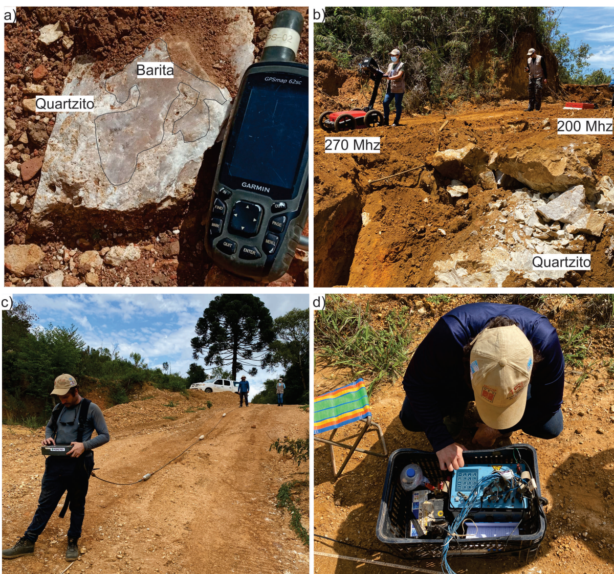
Figura 5.2 – A) Bloco rolado de barita envolto por quartzito. b) Aquisição de GPR com antenas de 200 e 270 MHz. c) Aquisição de Resistividade Capacitiva. d) Aquisição de Eletrorresistividade.
