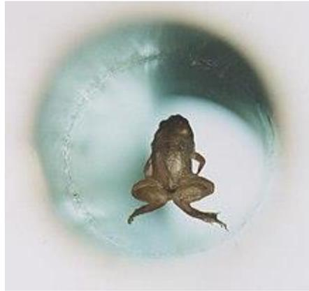
Figura 5 - Todos os materiais apresentam diamagnetismo. Um efeito decorrente disto é a levitação diamagnética que pode levitar qualquer material, até mesmo orgânicos como o sapo na imagem. O desafio desta técnica é a necessidade de campos magnéticos extremamente fortes (10 T no caso da imagem) devido à baixa intensidade do efeito diamagnético. Imagem adaptada de (HFML, 2023).
