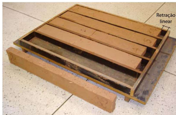
Figura 2.6- Teste de retração (teste da caixa): a caixa da ilustração permite o ensaio de cinco amostras, simultaneamente, facilitando a comparação entre os resultados de retração. Fonte: Neves et al (2009).
