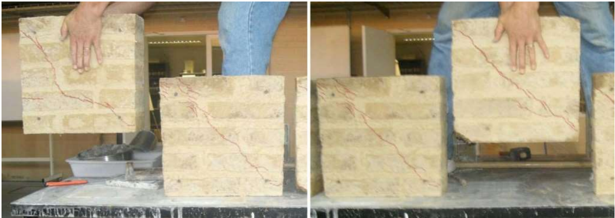
Figura 3.2 - Prismas já rompidos ao serem levantados apresentam aderência na área de ruptura. Fonte: Buson, Varum e Sposto (2010).
