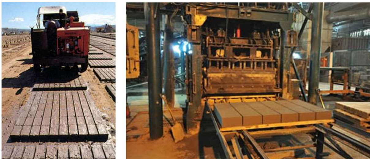
Figura A.9 – Equipamentos que misturam e extrudam a terra plástica e formam o adobe. Fontes: site Earth-auroville
