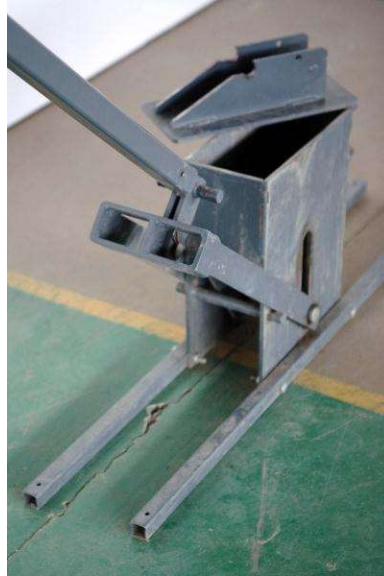
Figura 2.22 - Prensa manual CINVA-RAM. Fonte: site Cedric-alby
