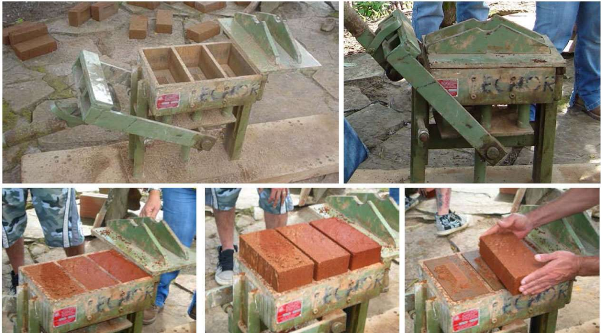
Figura 2.26 – Processo de moldagem do BTC. Fonte: Neves e Faria, 2011.
