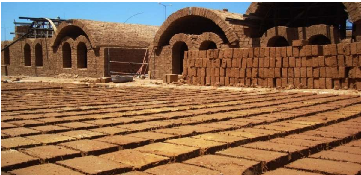
Figura A.10 – Fábrica de adobes em Sheikh Zayed, Palestina. Fonte: site Aventar
