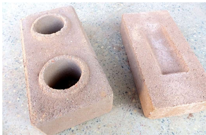
Figura 2.24 – Exemplos de BTC: furado com encaixe e maciço com reentrância. Fonte: arquivo do autor.
