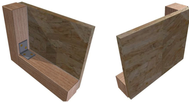
Figura5 - Fixação do revestimento na estrutura, a premissa que propunha que o revestimento trabalharia como contraventamento do painel orientou a ligação com redundância.
