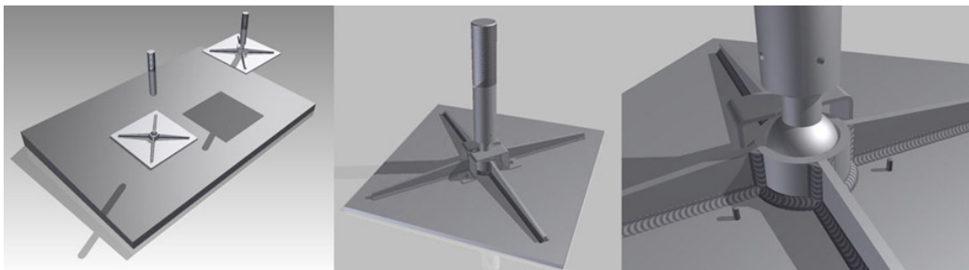
Figura 35 - A base da sapata - com a chapa de distribuição de esforços e o cálice - posicionado para receber o pino de apoio (esquerda); o conjunto do pino com junta universal montado, pronto para ser apoiado sobre um terreno (centro); detalhes da junta universal
