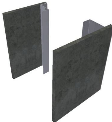
Figura 15 - Quadros de revestimento vertical, o material de acabamento, chapa cimentícia, está ligado com fixação permanente ao componente de interface, a moldura, de aço carbono.
