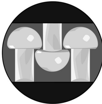
Figura 29 - Ilustração das hastes com a extremidade em forma de cogumelo. A fita selecionada continha cerca de 62 hastes por \text{cm}^2 . 44
