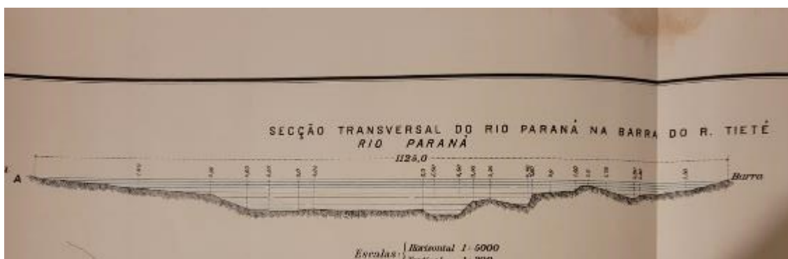
Figura 24: Acima, detalhe em planta do levantamento do encontro do rio Tietê com o rio Paraná e o Salto do Urubupungá. Abaixo, seção transversal do rio Paraná, junto à foz do Tietê. Os levantamentos também compreendiam a profundidade dos rios vislumbrando as possibilidades de navegação. Fonte: Relatório da Comissão Geográfica e Geológica do Estado de São Paulo – Exploração do Rio Paraná – 2ª Edição, 1911.
