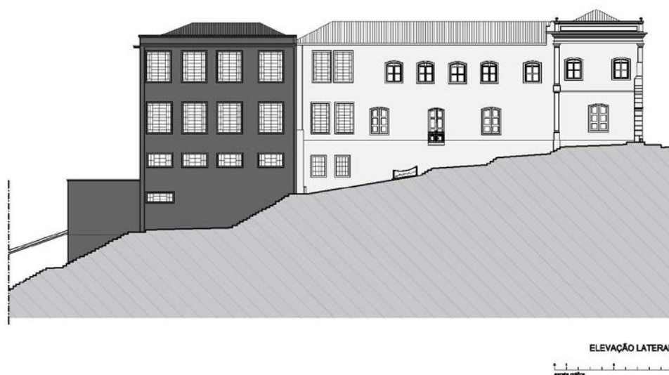
Imagem 6. Elevação lateral do Solar da Marquesa de Santos. O volume mais claro indica o edifício antigo, e o mais escuro o edifício construído pela Companhia de Gás. Autoria: Alex Ninomia, 2020.
