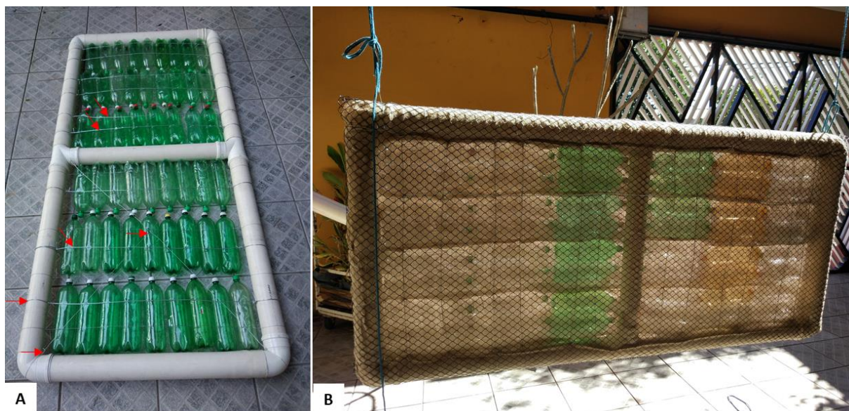
Figura 19 - Protótipo #5. A) Moldura de tubos PVC com uma divisão central (dimensões 2,42 x 1,16 x 0,10 m), fios de arame galvanizado de 2,7mm (setas vermelhas) e preenchimento com 54 garrafas PET; B) Alagado flutuante construído com acabamento externo com tecido de juta e tela plástica com malha de 25mm, mostrando garrafas utilizadas no preenchimento. Note em (B) que este protótipo permite a utilização de garrafas de diferentes formatos e tamanhos, pois não depende de encaixe formado entre garrafas de mesmo modelo. Fonte: Elaborado pelo Autor, 2018.
