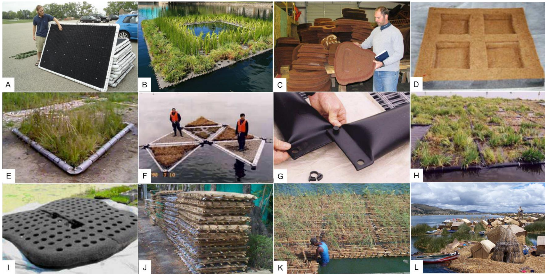
Figura 4 – Exemplos materiais utilizados para construção de alagados flutuantes construídos. A) Estrutura em PVC e telas plásticas da Grassroots Ecological Design (2012); B) placas de EVA com nicho para plástico para plantio da Beemats Floating Wetlands; (C e D) fibra orgânica (HEADLEY; TANNER, 2006; GREEN FUTURES LAB, 2013a); plataformas industriais com estrutura metálica triangular (E) com módulos instalados (F) da Bestmann Green System (HEADLEY; TANNER, 2006); I) matriz feita com garrafas PET triturada e espuma expandida da BlueWing Floating Treatment Wetlands (GREEN FUTURES LAB, 2013a); plataformas feitas com bambu e fibra de coco (J) instaladas no rio Kshipra na Índia (K) (HEADLEY; TANNER, 2006); L) Ilhas flutuantes de Uros, no lago Titicaca, fronteira entre Bolívia e Peru, feita com fibra de totora ( Schoenoplectus californicus subsp. tatora ) (PORRAS, 2007).
