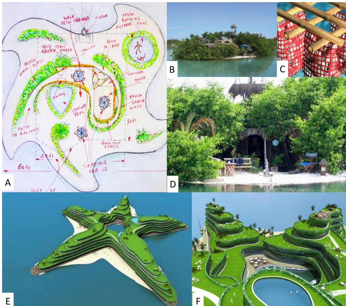
Figura 9 – Projetos de alagados flutuantes construídos com viés residencial. São apresentados os projetos Spiral Island construído no México (A-D) e das Ilhas Maldivas (E-F). Estão representados o rascunho da vista aérea (A), a ilha pronta (B), da estrutura de suporte e flutuação (C) e da casa (D) da Spiral Island . Estão representados os renderings da alagado flutuante em vista aérea (E) e em detalhe (F) demonstrando o enfoque hoteleiro de alto padrão. Fonte: modificado de Green Future Labs (2013a) e Owano (2012).
