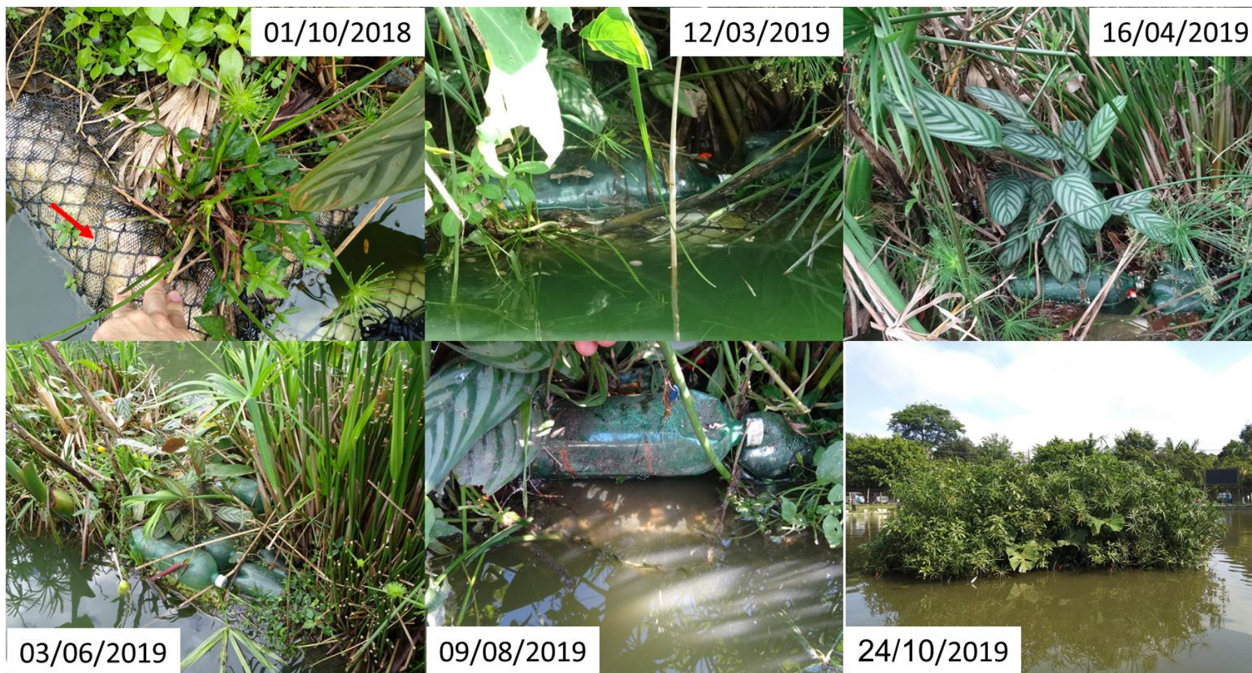
Figura 28 - Acompanhamento da performance estrutural do alagado flutuante construído (AFC) instalado no lago do Pesqueiro. A data do registro fotográfico está indicada no canto das figuras. É possível verificar aspectos estruturais com o avanço temporal da pesquisa. A partir de 12/03/2019 (221 dias após instalação) foi verificado que o arame galvanizado havia oxidado e algumas garrafas começaram a se desprender. As fotos de 03/06 e 09/08 mostram garrafas sem fixação do arame, deslocadas da moldura, porém na mesma posição inicial, provavelmente mantidas pela vegetação. Mesmo com a liberação de algumas garrafas, o AFC manteve-se flutuando e com vegetação se desenvolvendo como demonstrado em 24/10/2019. Fonte: Imagens do acervo pessoal do Autor.
