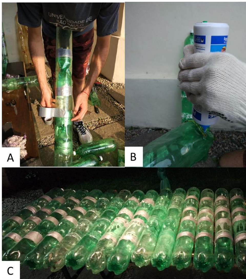
Figura 16 - Colagem de tubos para protótipo #3. Em (A) e (B) são apresentadas colagens dos tubos utilizando respectivamente fita silver tape e cola de poliuretano. Em (C) são apresentados os tubos formados com os diversos tipos de adesivo e suas combinações. Fonte: Elaborado pelo Autor, 2018.
