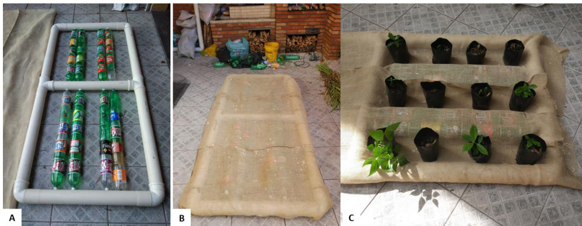
Figura 17 - Protótipo #4. A) Moldura de tubos PVC com uma divisão central (dimensões 2,42 x 1,16 x 0,10 m) e o posicionamento dos tubos formados por garrafas PET com 4 peças inteiras e 3 cortadas como conexão; B) Revestimento externo com tecido de juta; C) Posicionamento de mudas simulando a posição do plantio de macrófitas emergentes. Fonte: Elaborado pelo Autor, 2018.
