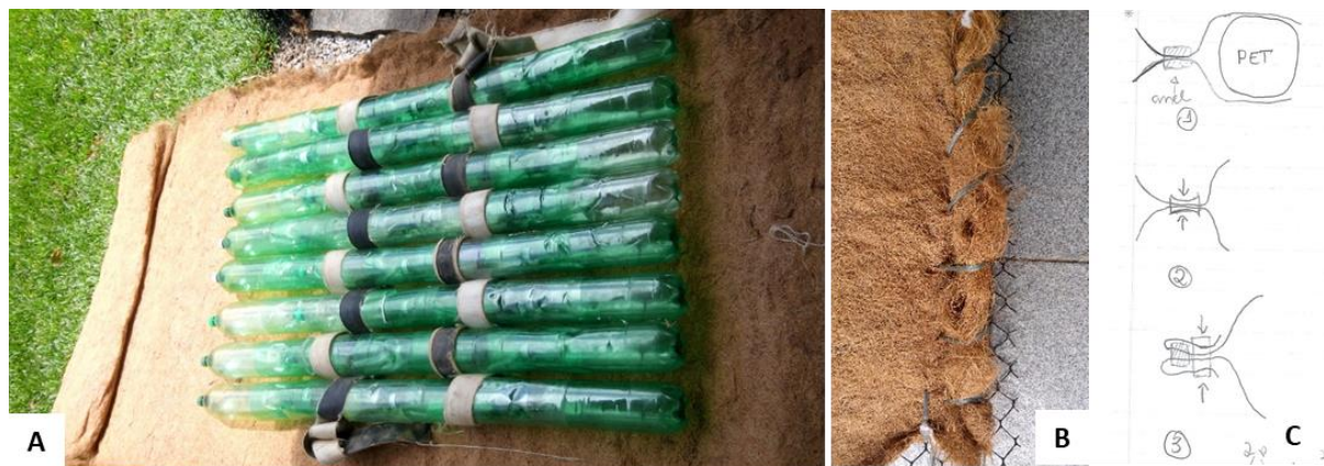
Figura 15 - Protótipo #2. A) Tubos compostos por 4 garrafas PET inteiras e 3 garrafas cortadas servindo como encaixe, amarrados com mangueira de bombeiro; B) Detalhe de amarração da fibra de coco e tela plástica envolvendo os tubos; C) Croqui de possibilidades de fixação final das mangueiras de bombeiro. Fonte: Elaborado pelo Autor, 2018.
