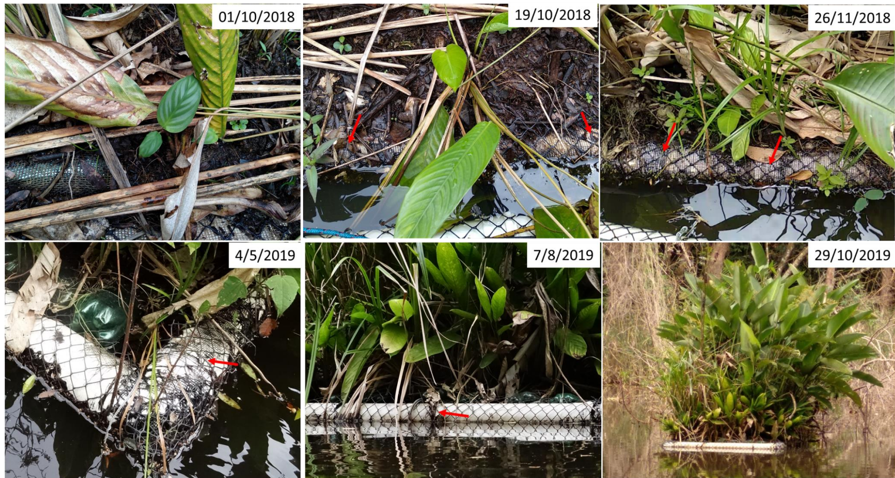
Figura 27 - Acompanhamento da performance estrutural do alagado flutuante construído (AFC) instalado no lago da Reserva. A data do registro fotográfico está indicada no canto das figuras. É possível acompanhar a degradação da cobertura de juta, que começou a soltar fragmentos em 04/05/2019 (272 dias após instalação). Setas vermelhas apontam para fios de arame, que até 07/08/19 (367 dias após a instalação) se apresentavam com pequenos indícios de oxidação em alguns pontos, porém com fios íntegros e mantendo as estruturas fixas. Imagem em 29/10/2019 demonstrando AFC em pleno funcionamento. Fonte: Imagens do acervo pessoal do Autor.
