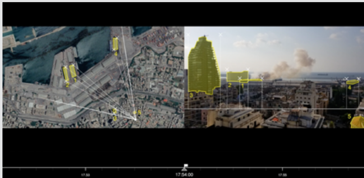
Fig. 18 Exemplo da geolocalização de uma imagem. A imagem coletada via OSINT, à direita (imagem A), foi a primeira imagem postada nas redes sociais mostrando uma nuvem de fumaça saindo do armazém do porto, indicando um incêndio, às 17h54. Para geolocalizar essa imagem, o FA a compara com uma imagem de satélite da região portuária, à esquerda (imagem B), e identifica os edifícios presentes em ambas as imagens. Desta forma, eles conseguem calcular o cone de visão da imagem A e determinar sua localização. Fonte: (Forensic Architecture, 2020b).
