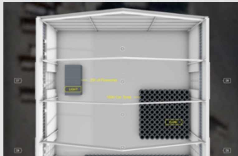
Fig. 30 Modelo do armazém mostrando o posicionamento dos sacos de nitrato de amônia, pneus e fogos de artifício. Fonte: (Forensic Architecture, 2020b).
