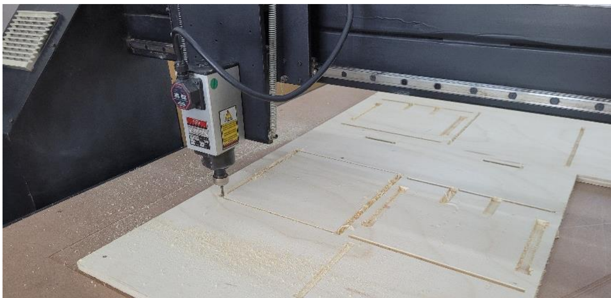
Figura 72. Prototipagem do módulo na fresadora CNC de grande formato
