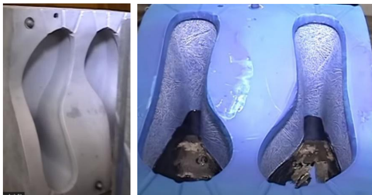
Figura 21: Texturização química em moldes para injeção de solados
