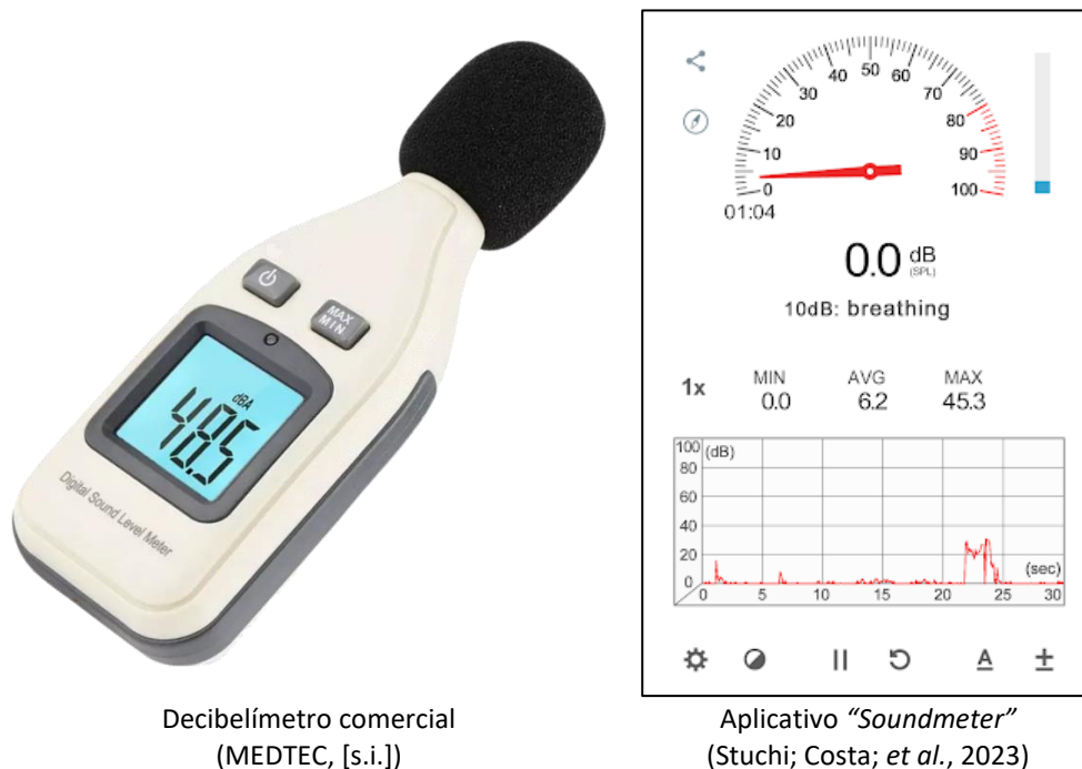
Figura 29 – decibelímetro comercial e aplicativo decibelímetro para smartphone
