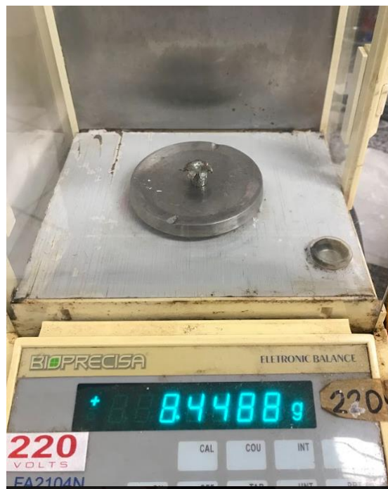
Figura 19 - Detalhe da repesagem de um projétil Copper Bullet Tactical em .40 S&W.
