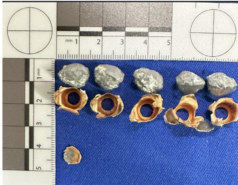
Figura 26 - Comportamento do projétil .40 S&W ETPP no E5, demonstrando a separação jaqueta/núcleo.
