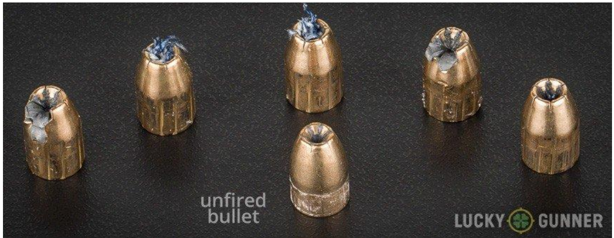
Figura 2 - Teste realizado em Clear ballistics ™, coberta com camadas de tecidos pesados, com munição CBC Bonded de 124 gr, calibre 9 x 19 mm.
