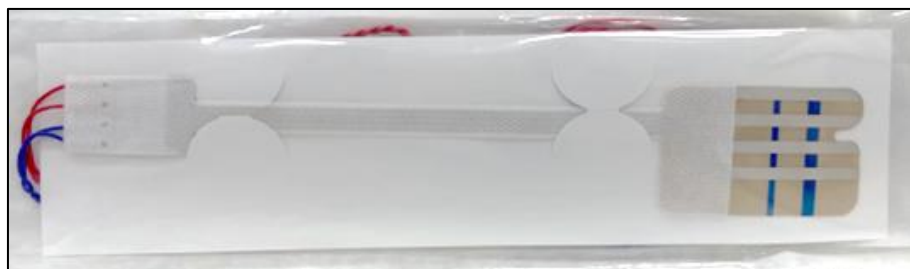
Figura 6 - Fotografia do eletrodo de registro do tipo adesivo usado para a monitoração intraoperatória do nervo laríngeo recorrente.
