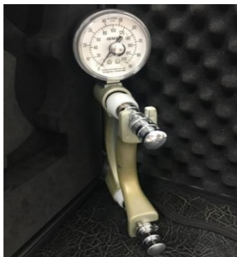
Figura 12 – Dinamômetro isométrico JAMAR ®
