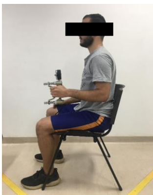
Figura 13 – Posicionamento para avaliação da força de preensão manual
