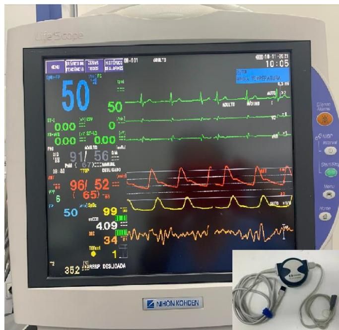
Figura 06: Monitor Triton (BSM) juntamente com o módulo BIS. Arquivo pessoal.
