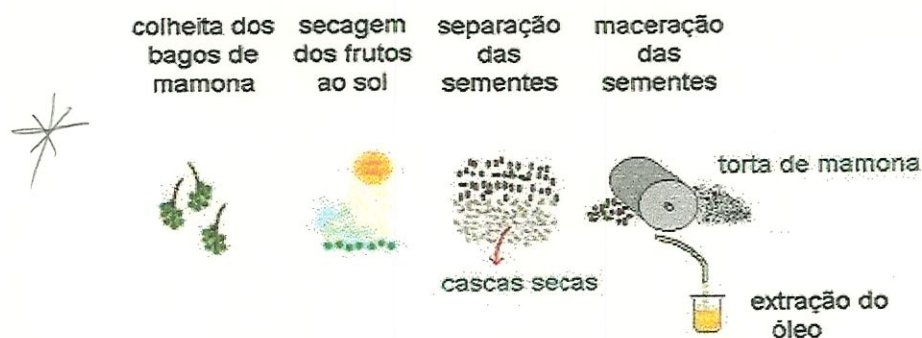
FIGURA 5 ESQUEMA DO PROCESSO DE OBTENÇÃO DO ÓLEO DA MAMONA
