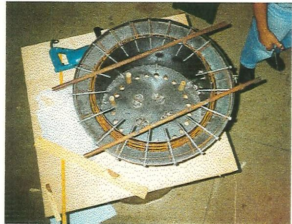
Figura 68 - Vista superior da peça 2 observando todas as previsões de furos para encaixes de pinos chumbadores e tubulações
