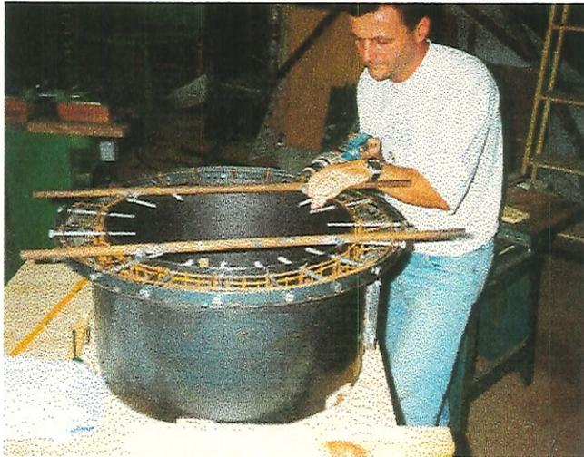
Figura 67- Detalhe fôrma, da armadura e marcação dos pinos de solidarização da peça 2
