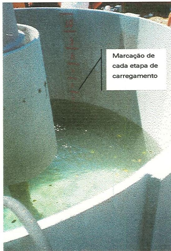
**Figura 84 - Detalhe de uma das etapas do ensaio de carregamento do modelo**
