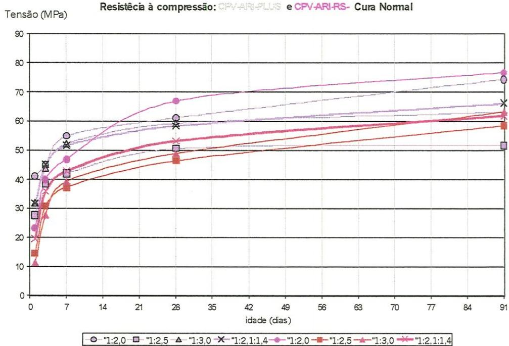
Figura 28- Resistência mecânica das misturas com cimento de alta resistência inicial sob cura normal
