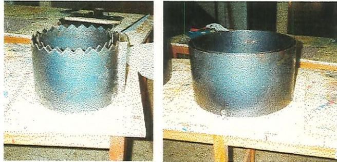
**Figura 60 - Fôrmas metálicas utilizadas para as câmaras de coleta e distribuição do afluente respectivamente**
