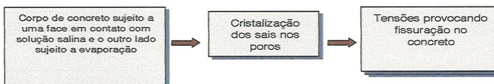
**Figura 09- Mecanismo de fissuração do concreto devido cristalização dos sais nos poros**
