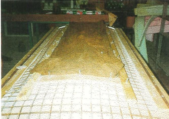
**Figura 58- Processo inicial de cura dos setores de parede pré-moldados**
