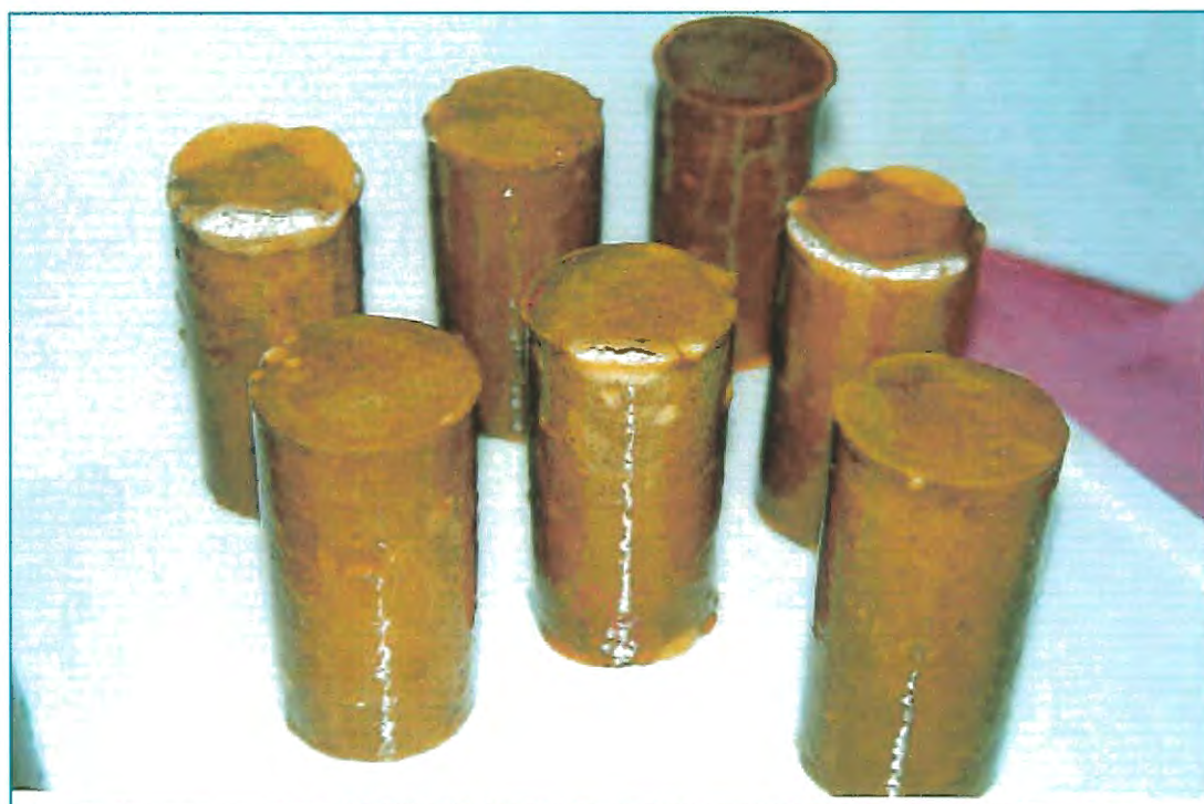
FIGURA 41 – Corpos de prova revestidos com poliuretana de origem vegetal após 21 dias de imersão em solução com alta concentração de ácido sulfúrico (20%).
