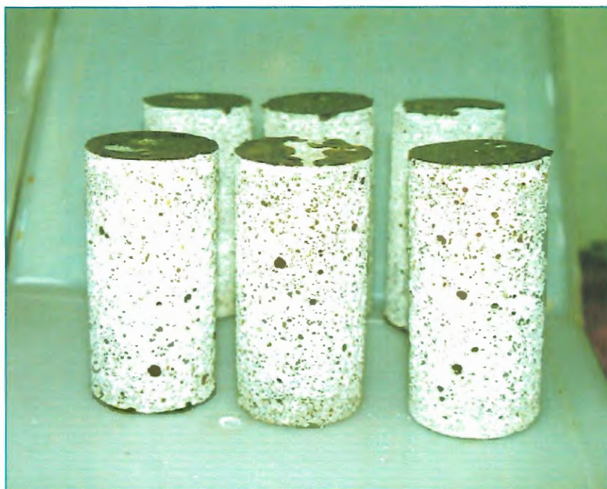
FIGURA 43 – Corpos de prova revestidos com metacrilato após 20 dias de imersão em solução agressiva com alta concentração ácida.
