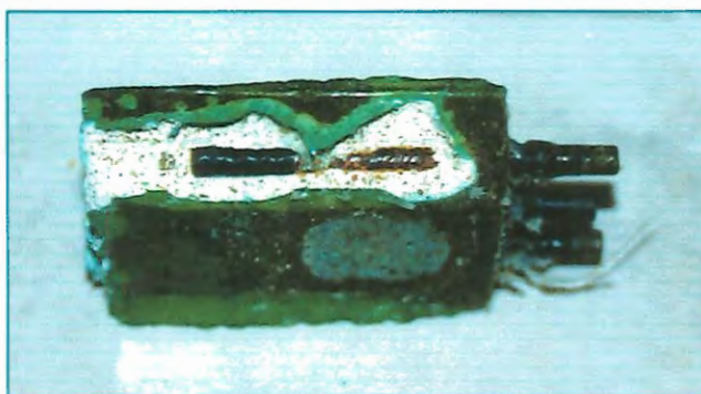
FIGURA 73 – Corpo de prova revestido com sistema epóxi B apresentando armadura exposta.
