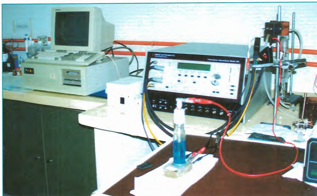
FIGURA 30 – Potenciostato/galvanostato monitorado por computador.
