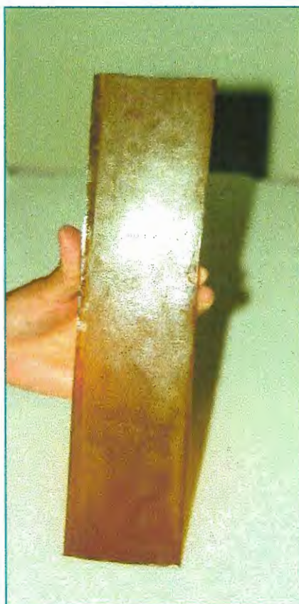
FIGURA 21 – Placa de filme livre constituída por polímero poliuretano vegetal, para a colocação na câmara de intemperismo artificial.
