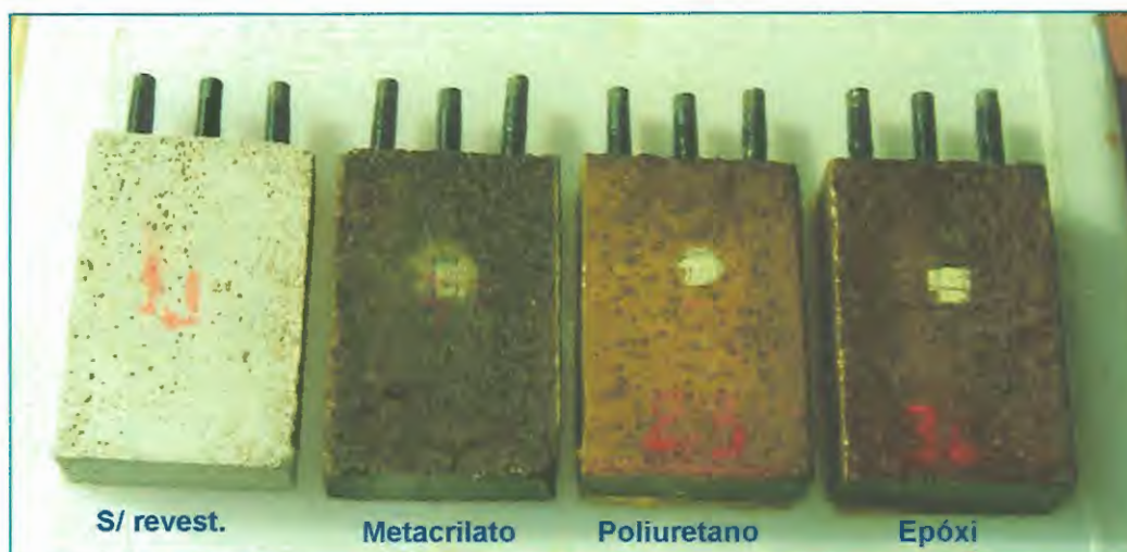
FIGURA 28 – Corpos de prova moldados e revestidos para o ensaio de avaliação da proteção contra a corrosão.
