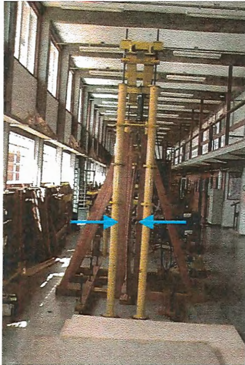
FIGURA 48 – CHAPA 1 C de madeira compensada atingindo a flambagem.
