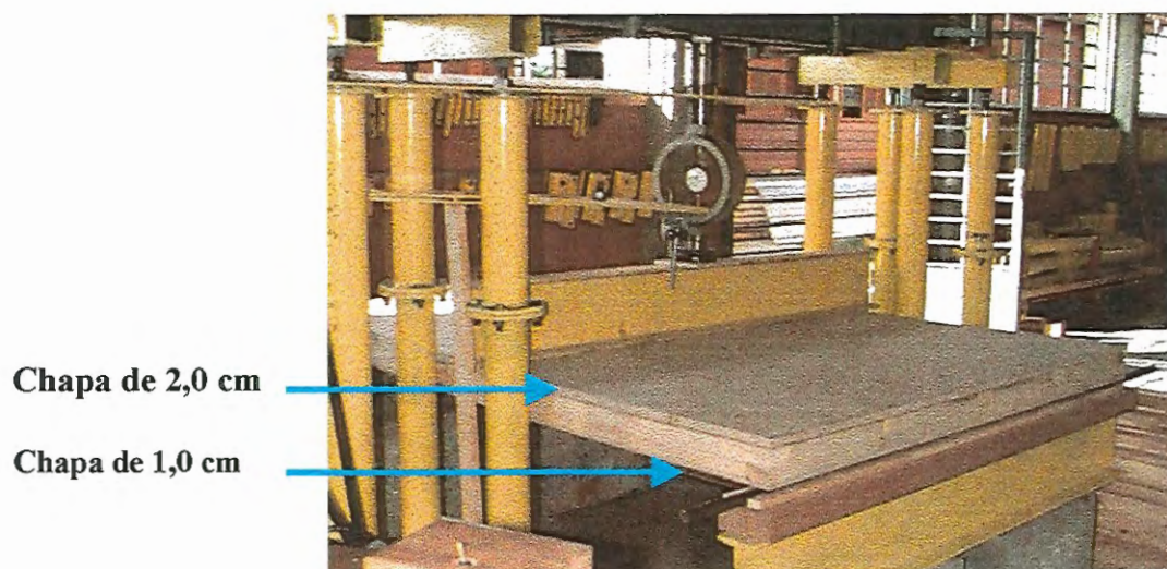
FIGURA 70 – PAINEL 5 C preparado para ser ensaiado.
