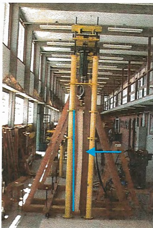
FIGURA 57 – PAINEL 3 C de madeira compensada em flambagem.
