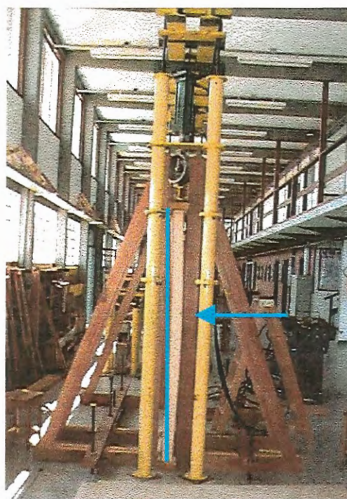
FIGURA 53 – PAINEL 2 C de madeira compensada em flambagem.
