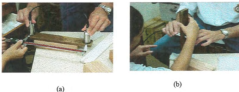
FIGURA 79 – Parte (a) mostra a leitura do tempo de propagação na superfície da amostra e a parte (b) mostra a leitura do tempo de propagação ao longo da espessura da amostra.
