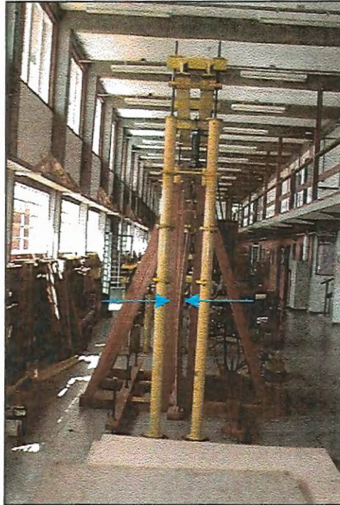
FIGURA 42 – CHAPA 3 A de madeira aglomerada atingindo a flambagem.
