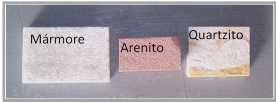
Figura 4.15- Corpos de prova das rochas para a execução do ensaio de índices físicos .
