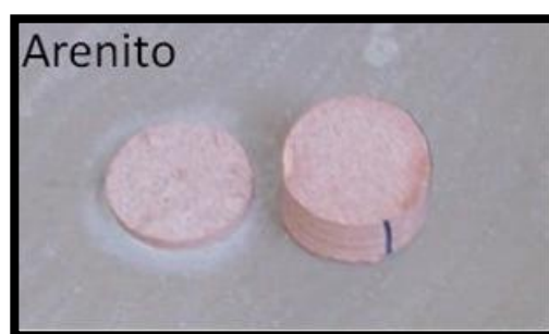
Figura 6.32- Corpo de prova após o ensaio do arrancamento das rochas assentadas com a argamassa para porcelanato.
