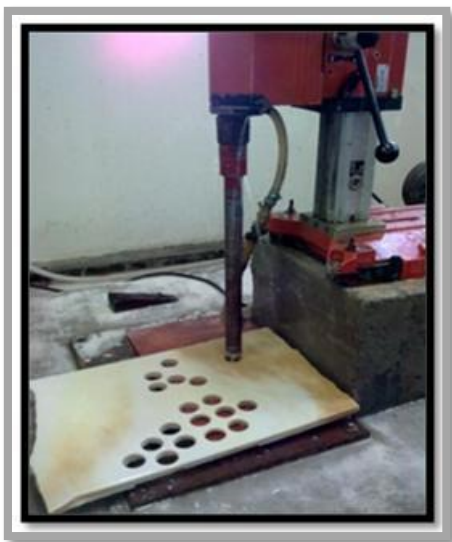
Figura 4.16- Furadeira de coluna, extraindo o corpo-de-prova do quartzito.
