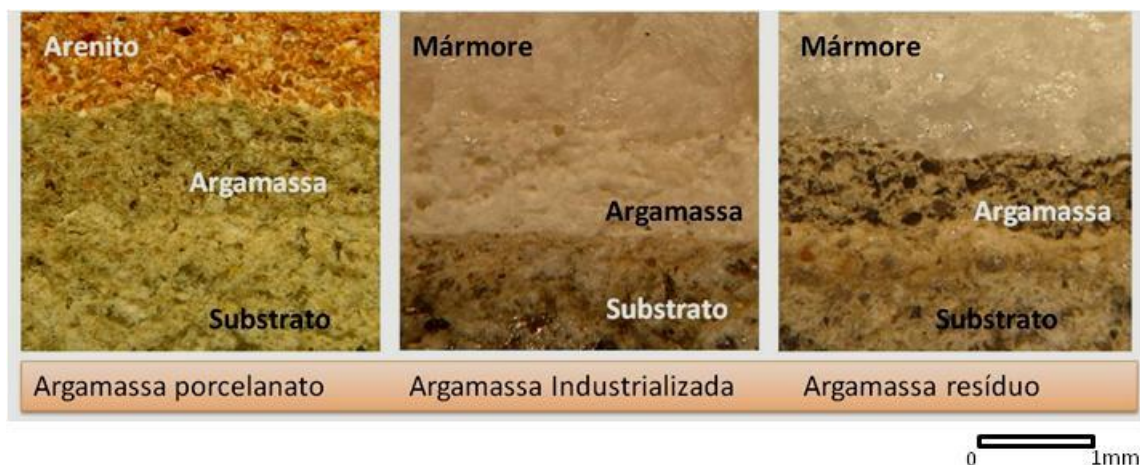
Figura 6.36- Perfil do substrato-argamassa-rocha.
