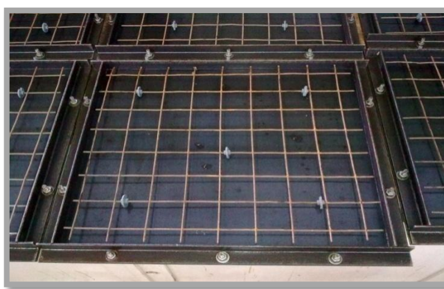
Figura 4.11- Molde metálico com a tela de aço e espaçadores plásticos
