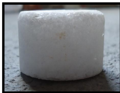
Figura 5.27- Corpo de prova do mármore com as laterais retas.
