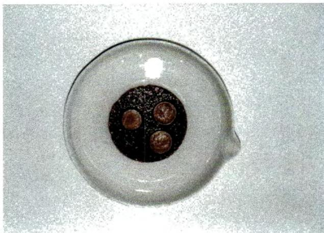
Figura 4.3: Pastilhas de solo submetidas à infiltração de água (diâmetro do molde 20 mm).
