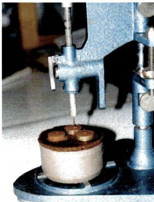
Figura 4.4: Penetração nas pastilhas de solo.
