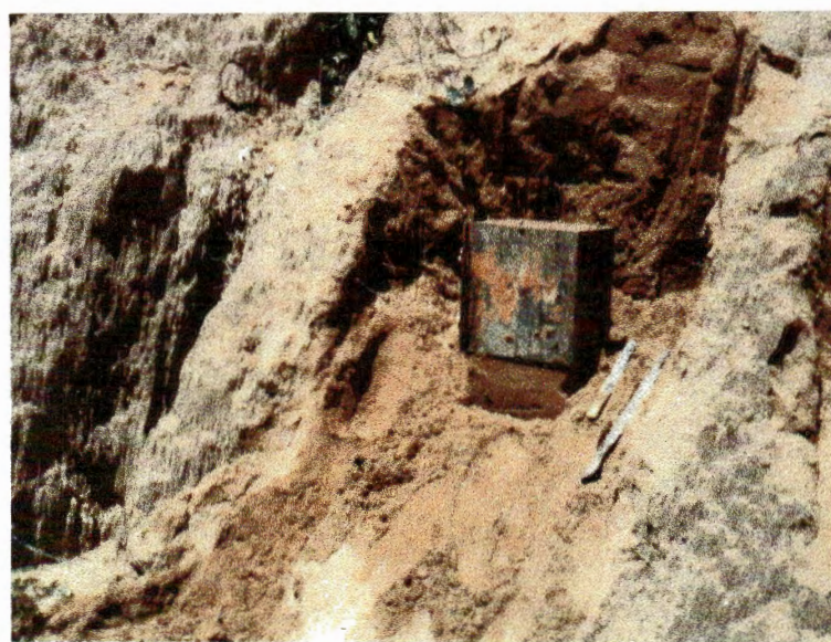
Figura 3-1 - Retirada de amostras indeformadas.
