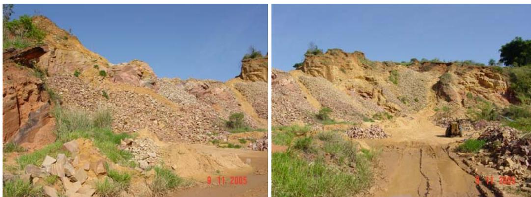
Figura 7.69: Pedreira em atividade; exploração dos arenitos silicificados da Formação Botucatu.
