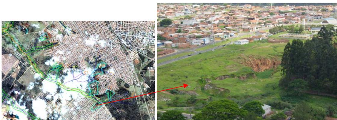
Figura 7.11: Boçoroca ocasionada pela intensidade das águas pluviais no bairro Cidade Aracy, onde houve desmatamento inadequado.
