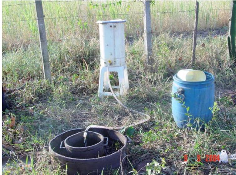
Figura 5.5: Esquema de montagem e execução do ensaio de infiltração pelo método do Anel Duplo.
