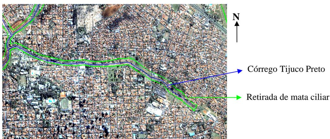
Figura 7.50: Micro-bacia do Córrego Tijuco Preto totalmente urbanizada e degradada pela retirada da mata ciliar.
