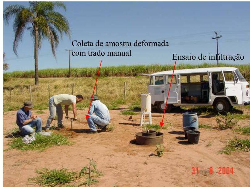
Figura 5.8: Posicionamento das diferentes atividades durante o ensaio de infiltração.
