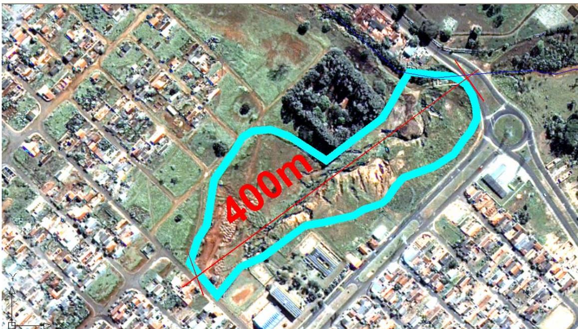
Figura 8.1: Imagem Ikonos sobreposta com o vetor de degradação por erosão (local: Bairro Cidade Aracy), onde foi possível obter dimensões da área, como por exemplo, o comprimento da erosão.
