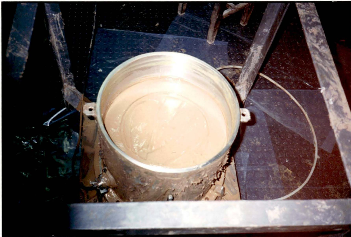
FOTO 6.2 - Regularização da lama após a mistura homogênea do solo com água.
