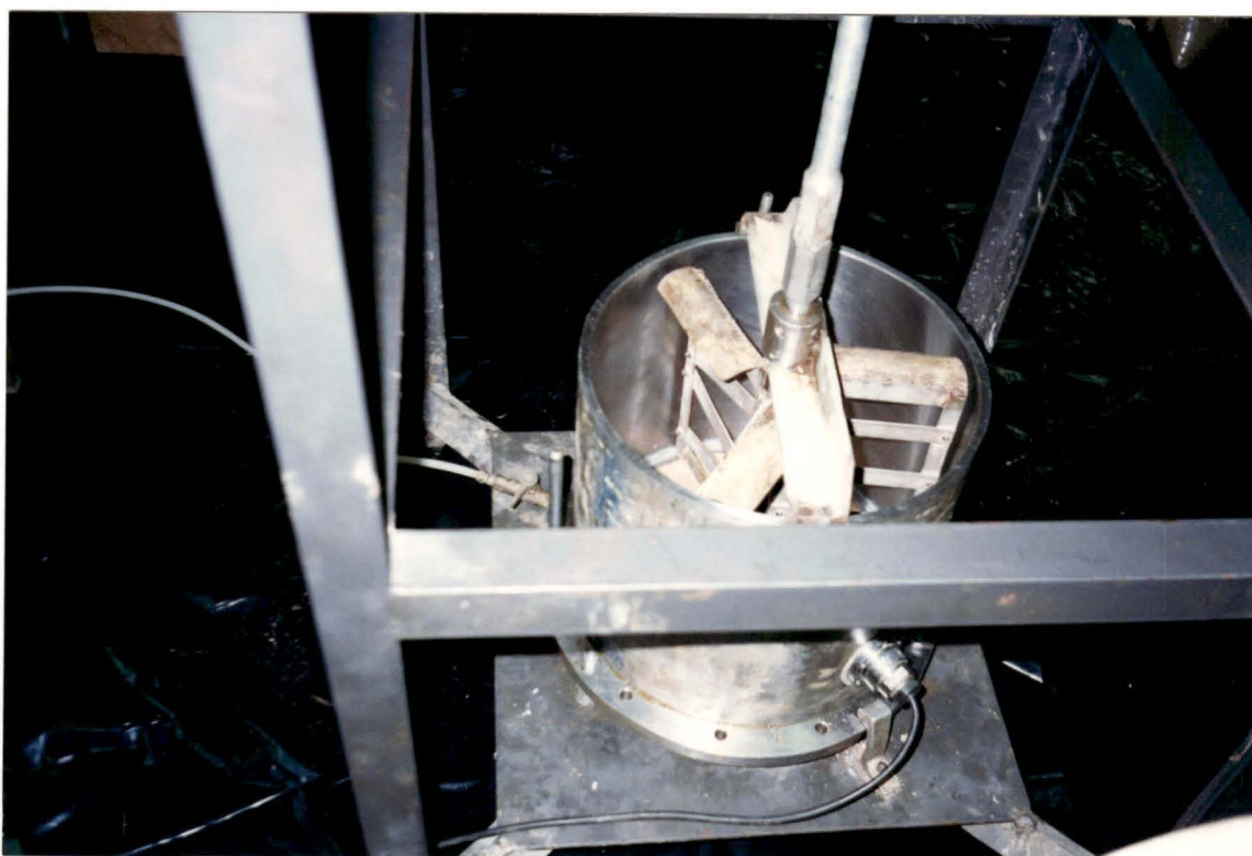
FOTO 4.1 - Equipamento para execução da lama.
