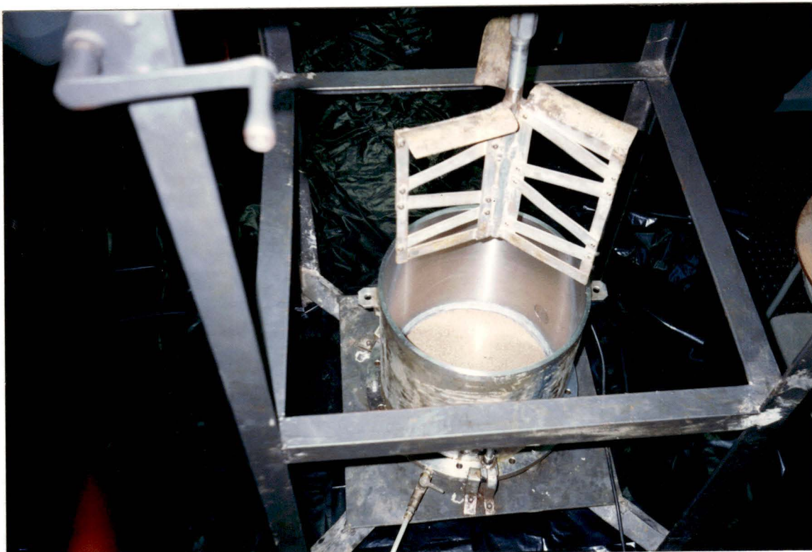
FOTO 4.2 -. Batedor para execução da lama.
