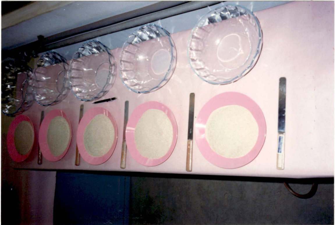
FOTO 4.6 - Areia e Araldite para a pedra porosa, fracionados em partes iguais para melhor homogeneização.
