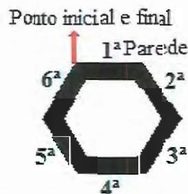
Figura 4.28 – Esquemática mostrando a disposição de cada parede, formando um hexágono que representa um retículo. O ponto inicial da primeira parede é o término da última parede.
