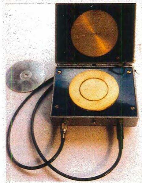
Figura 14: Célula de eletrodos para a medição da permissividade e do fator de dissipação dielétrico.
