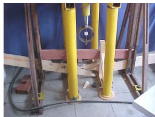
Figura 114 – Ruptura frágil por tração.
