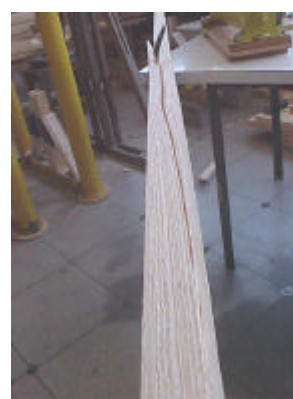
Figura 116 – Ruptura devido à inclinação de fibras.
