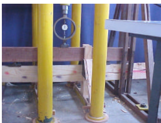
Figura 115 – Ruptura por cisalhamento.
