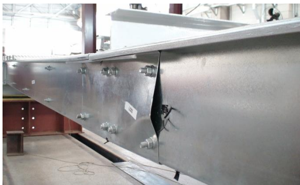
Figura 4.39 – Mecanismo de falha atípico na extremidade da luva do protótipo ZC83-L63.
