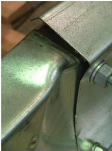
a) Falha local-distorcional
