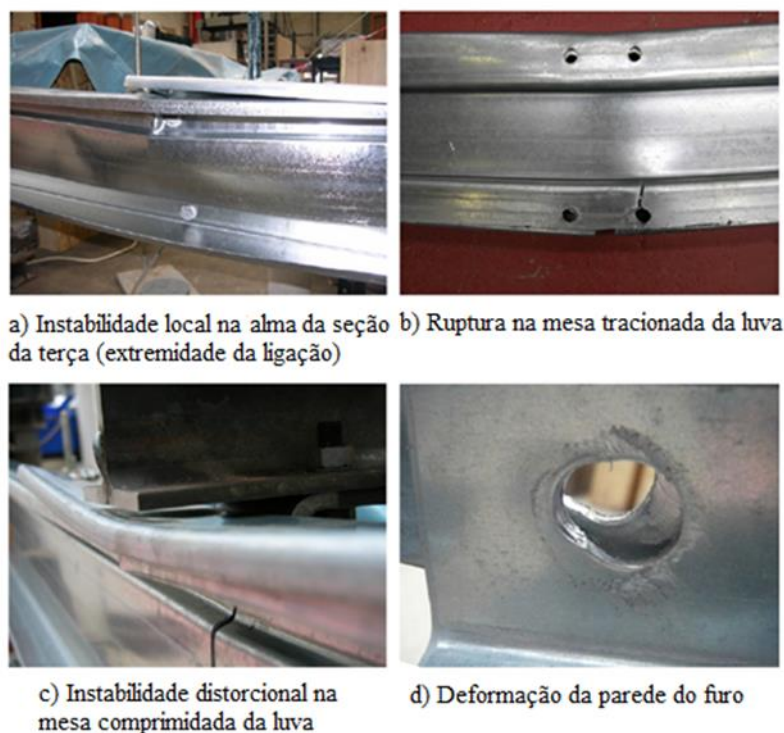
Figura 2.14 – Modos de falha da ligação (adaptada de YANG E LIU, 2012).
