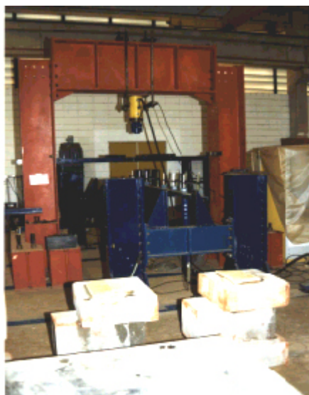
Figura 4.3 – Pórtico de reação Fonte: RIBEIRO (1998)
