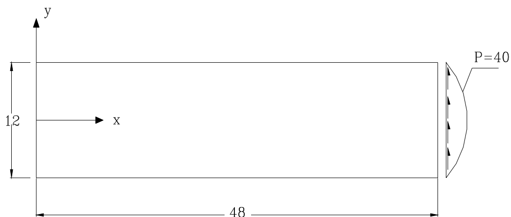
FIGURA 5.1 - Viga em balanço
