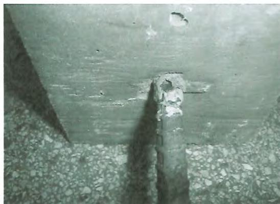
Ruptura por deslizamento da barra
