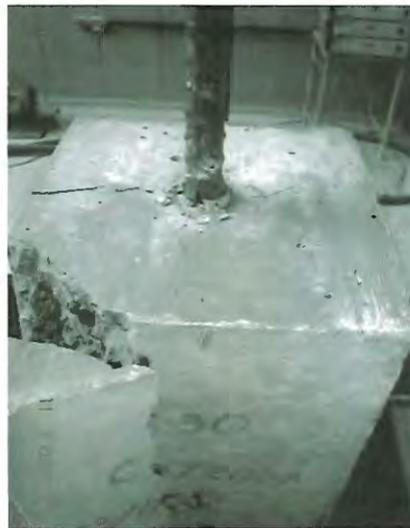
Ruptura por deslizamento da barra
