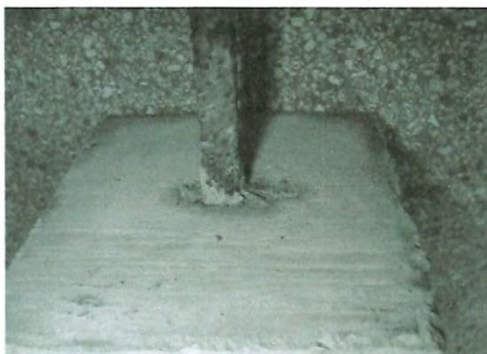
Ruptura por deslizamento da barra
