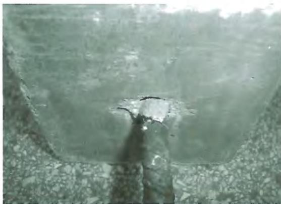
Ruptura por deslizamento da barra
