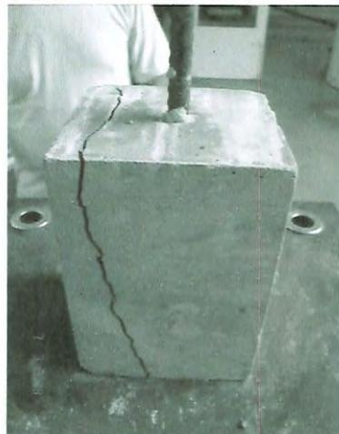
Ruptura a do concreto por flambagem da barra
