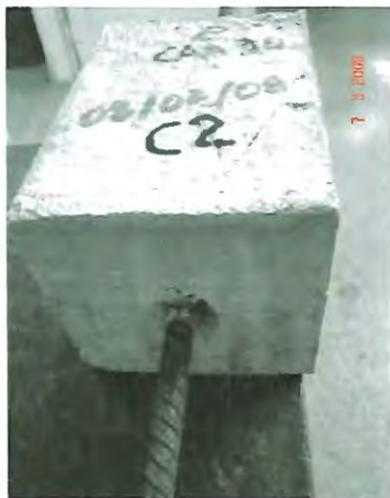
Ruptura por deslizamento da barra
