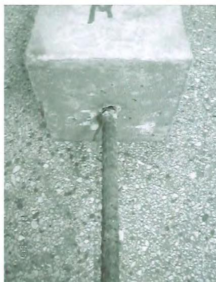
Ruptura do concreto por fendilhamento barra Vista inferior
