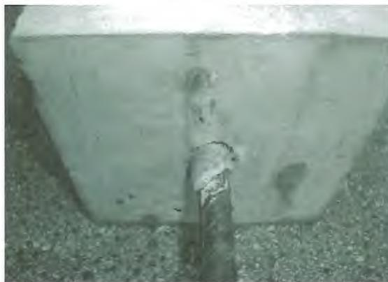
Ruptura por deslizamento da barra
