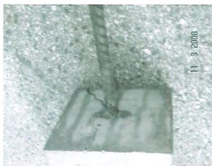
Ruptura do concreto por fendilhamento na barra Vista superior
