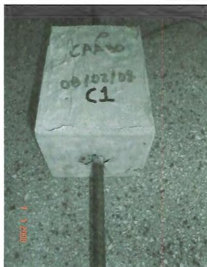
Ruptura por deslizamento da barra
