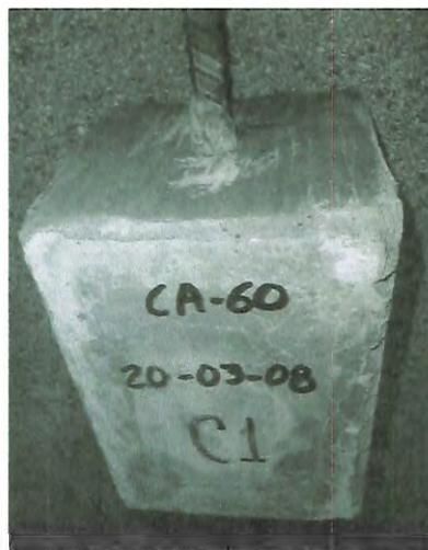
Ruptura por arrancamento por deslizamento da barra
