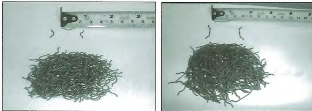
Figura 3.24 Fibras de aço de 13 mm e 25 mm
