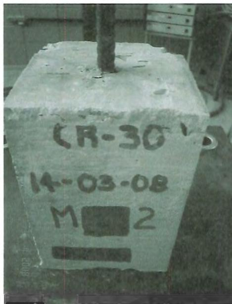
Ruptura por deslizamento da barra
