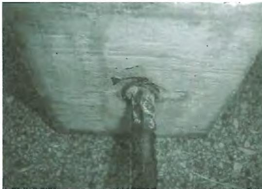
Ruptura por deslizamento da barra
