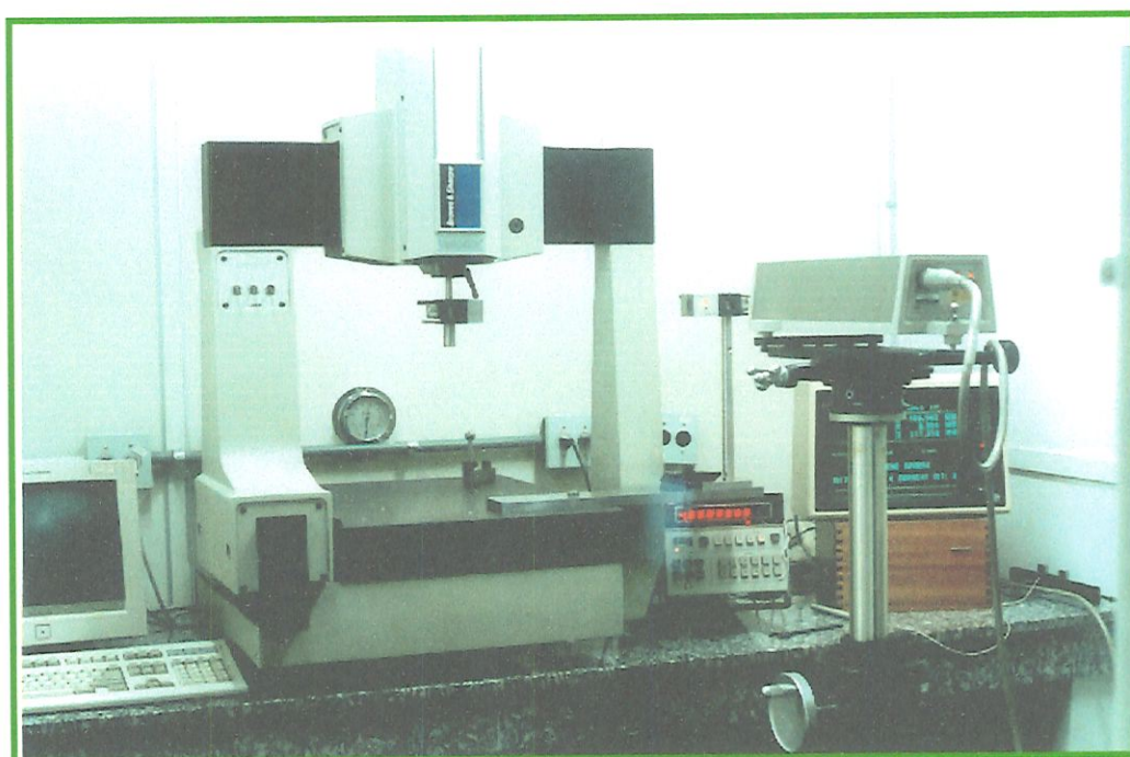
Figura 5.5: Calibração do erro de Posição do Eixo “X”.
