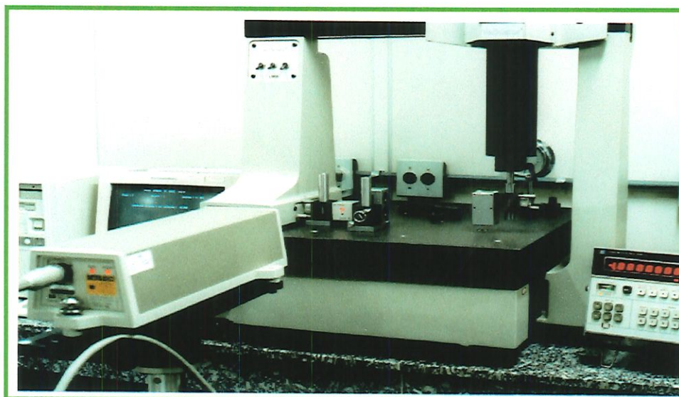
Figura 5.10: Calibração do erro “Pitch” do eixo “X”.
