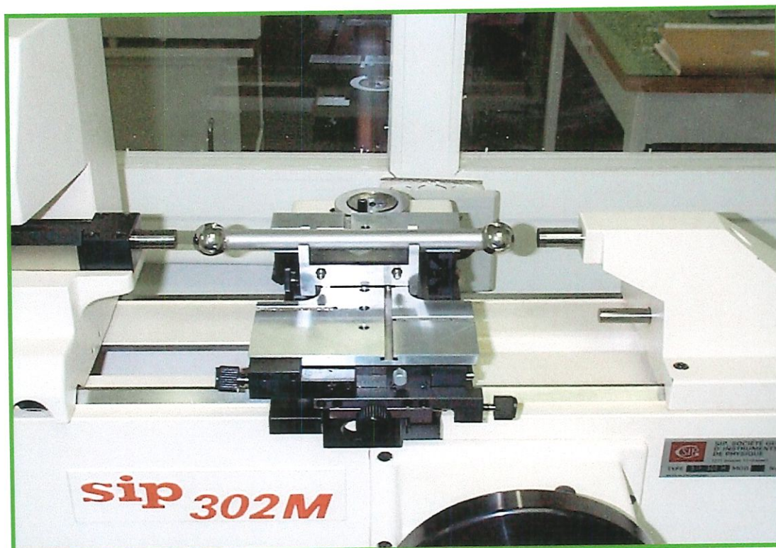
Figura 5.17: Medição do comprimento total da Barra de Esferas
