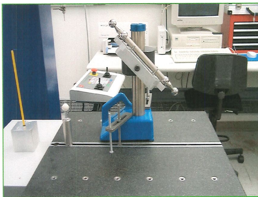
Figura 2.12: Calibração com Barra de Esferas. (Cortesia U.N.C Charlotte)
