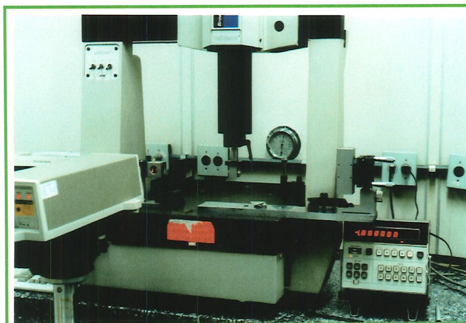
Figura 5.7: Calibração do erro de Retilidade do eixo “X” na direção de “Z”.
