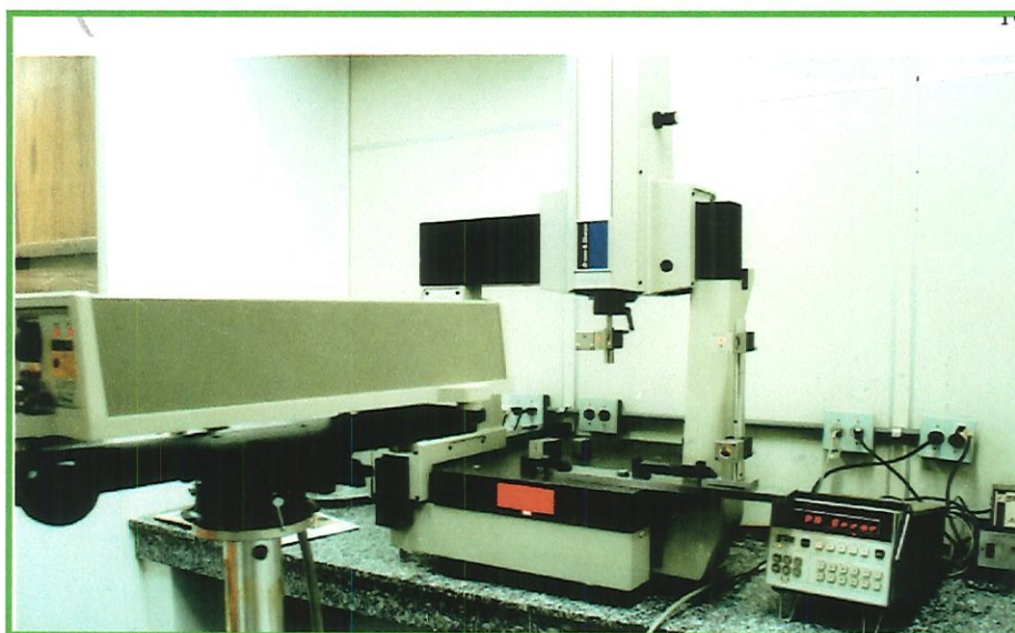
Figura 5.11: Calibração do erro de “Yaw” do eixo “X”.
