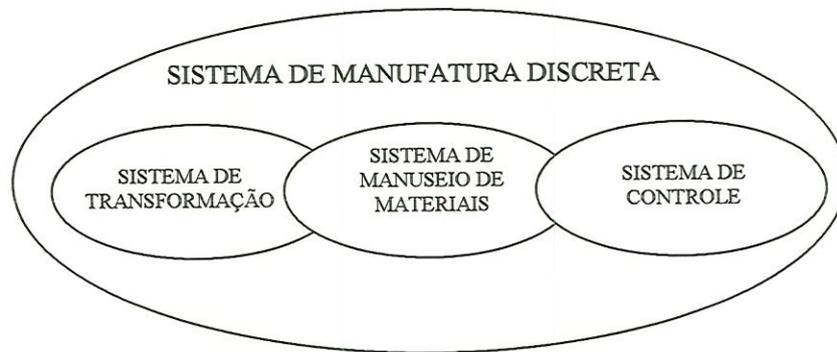
Figura 2.1 – Sistemas funcionais que compõe um Sistema de Manufatura.
