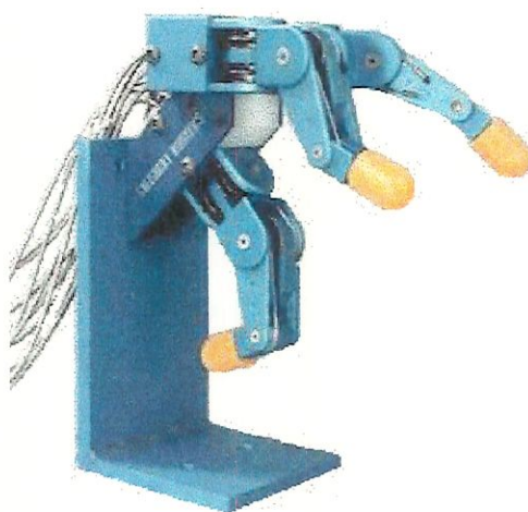
(A) Garra de STANFORD/JPL 3 dedos, 3 graus de liberdade por dedo Acionada por 12 cabos revestidos com teflon 12 sensores de tensão dos cabos
