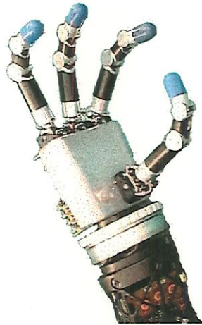
(A) Garra DLR 4 dedos, 3 graus de liberdade por dedo Acionamento (acoplado à palma) 25 sensores por dedo (tato, temperatura, força)
