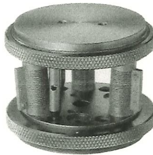
FIGURA 2 – Dispositivo especial de montagem, caracterizado por uma pequena rigidez a esforços laterais.
