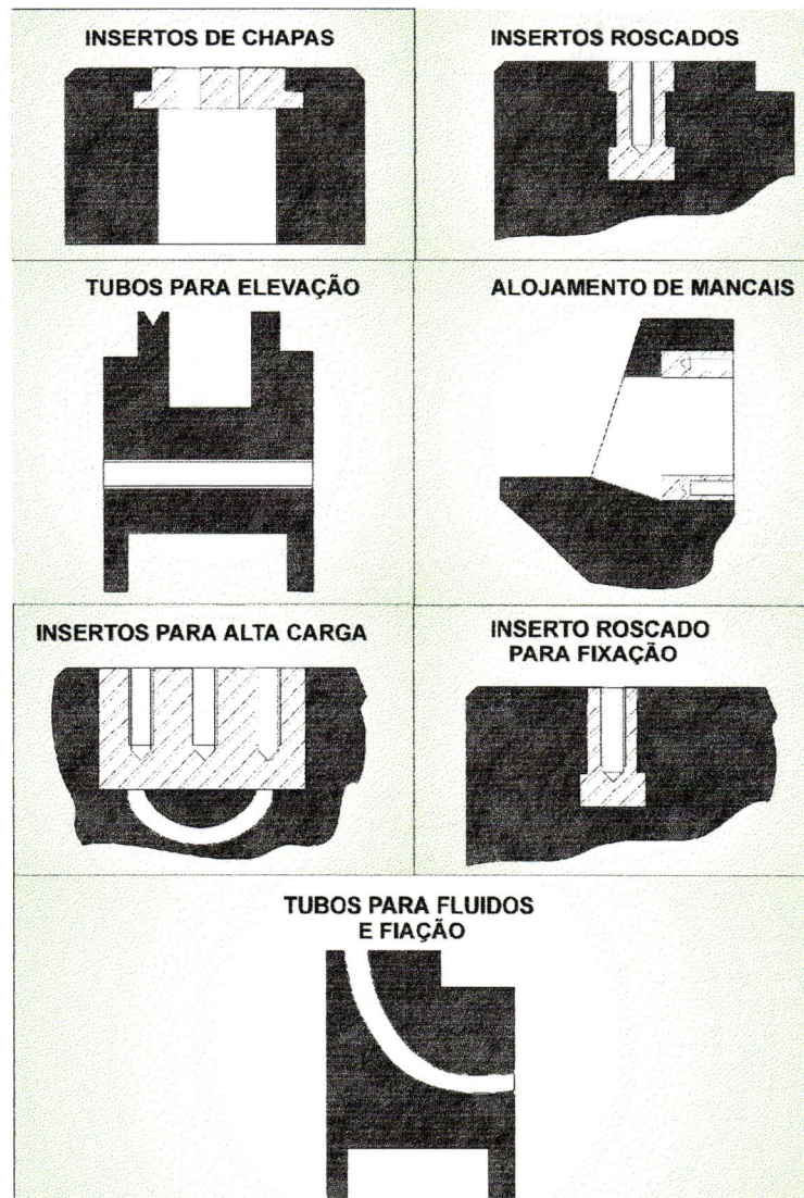
FIGURA 2.4 – Inserções para estruturas de granito sintético [RIBEIRO, 1998]
