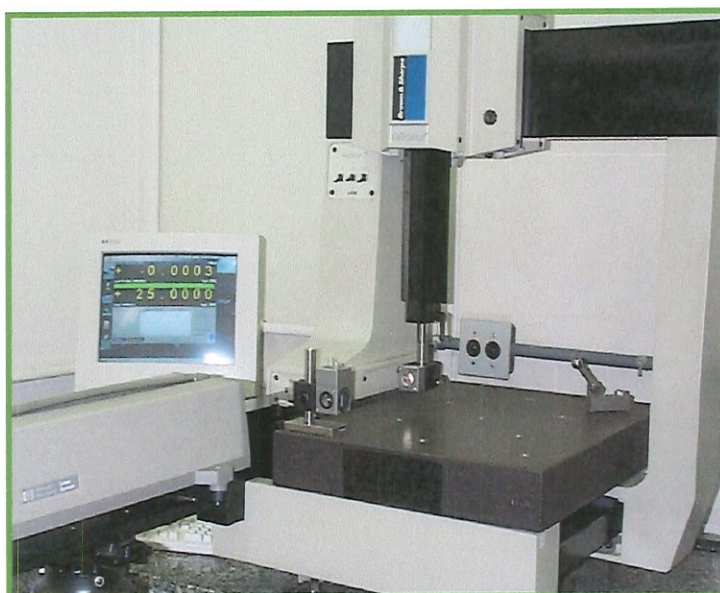
Figura 5.8: Montagem experimental para a medição da componente E_y do erro volumétrico
