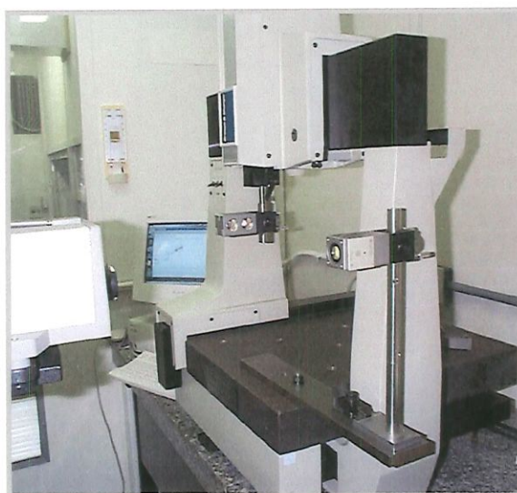
Figura C6: Montagem experimental para medir o erro YAW do Eixo X: az(x)
