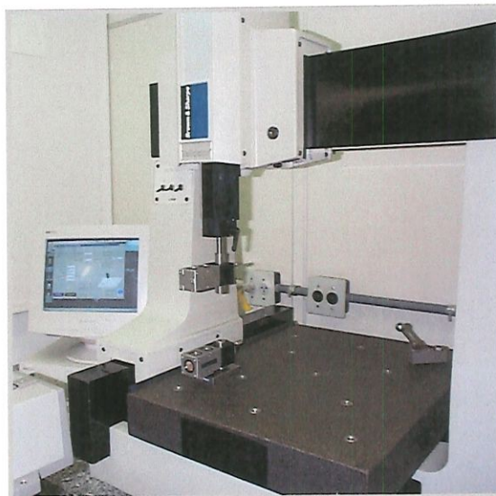
Figura C5: Montagem experimental para medir o erro PITCH do Eixo Z: ax(z)
