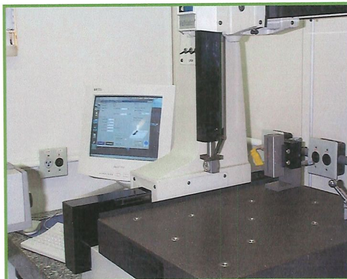
Figura C3: Montagem experimental para medir o erro de retilidade vertical do Eixo Y: t_z(y)
