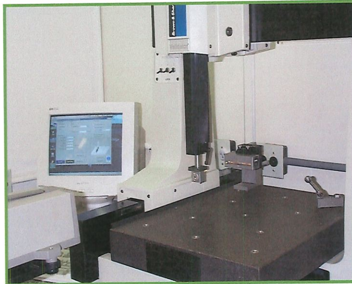
Figura C2: Montagem experimental para medir o erro de retilidade horizontal do Eixo Y: t_x(y)
