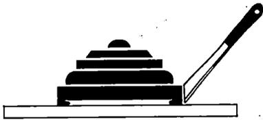
4. Monte a caixa de moldagem ao redor do original. Vede as extremidades da caixa também com massa tipo plastelina. Isto evitará o vazamento da borracha de silicone ainda na forma líquida. Se desejar produzir peças com superfície lisa e com brilho, assegure-se que o original esteja bem polido.
