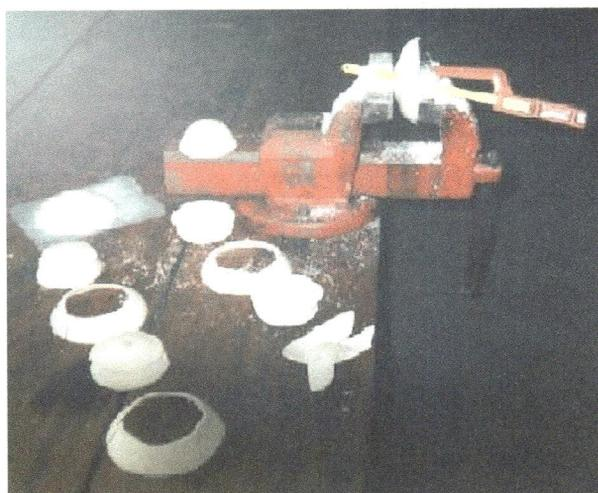
Desse modo foram obtidos 8 corpos de prova completos denominados do tipo D e 7 corpos de prova com a aba cortada denominados do tipo E. Estes corpos de prova foram colados ,com a utilização da própria resina de poliuretano à placas de Duratex® e no centro da parte inferior de cada placa foi feito um furo para posicionamento na base do banco de ensaios. Os corpos de prova prontos podem ser vistos na Figura 6.22.
