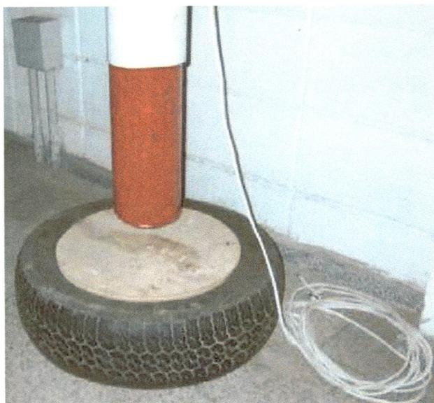
Figura 5.12 – Segunda tentativa de montagem da base, com o pneu amortecedor.
