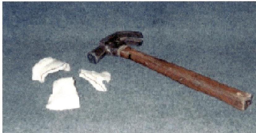
Figura 5.40 – Ruptura de um corpo de prova do tipo B na forma de estrela devido a um impacto experimental com um martelo.
