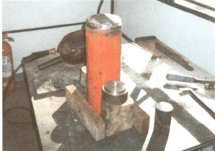
Voltando a realização dos testes, o cilindro foi completamente carregado com areia grossa de construção ficando com uma massa total de 11,8kg.
