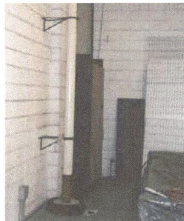
Figura 5.6 – Banco de ensaios montado – vista completa. A área ocupada no piso foi de 1,5 x 1,0 m enquanto que sua altura alcançou 7,0 m
