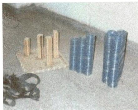
Para o sistema mola amortecedor (Figura 5.8) foi utilizado um pneu do tipo 185/70/14 da Goodyear ao qual foi acoplada uma base de madeira compensada com diâmetro de 400mm e espessura de 15mm, com 4 furos de diâmetro 10,0mm para permitir a passagem do ar, funcionando assim como uma amortecedor e com 3 reforços em Pinus de secção 40x50mm e comprimento de 200mm e 3 guias de Pinus de secção 60x40mm e altura de 70mm. A base montada é mostrada na Figura 5.9.
