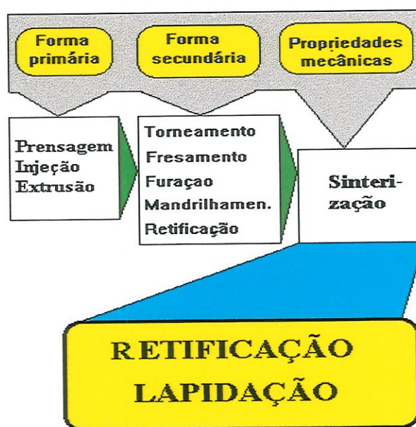
Figura 3-01: A usinagem na fabricação de elementos cerâmicos
