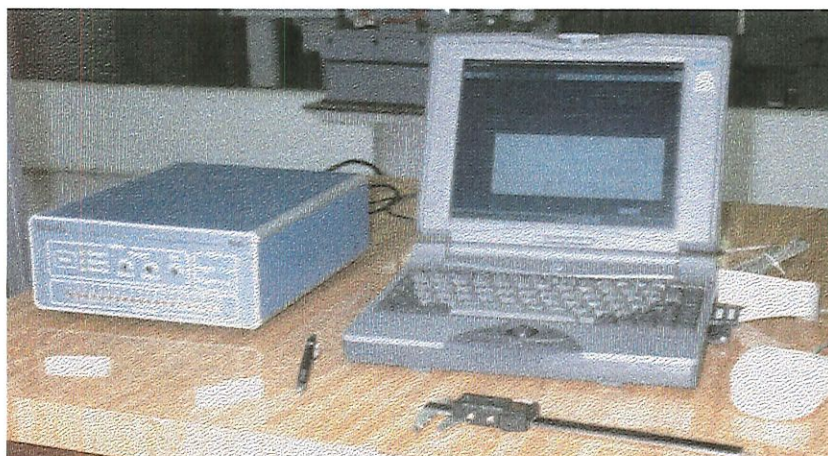
Figura 4-08: Unidade de monitoração de Emissão Acústica SENSIS BM-12
