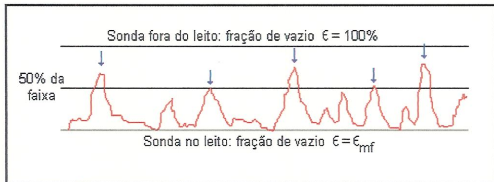
FIGURA A4 – Calibração dos sinais de uma sonda capacitiva sugerida por GELDART & KELSEY (1972). As setas indicam os picos que podem ser considerados bolhas.
