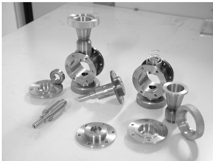
Figura 3.11 – Vista das válvulas rotativas desmontadas da planta de bancada.
