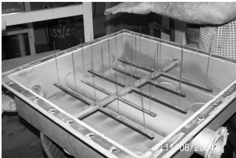
Figura 3.8 – Câmara plena com 23 agulhas injetoras do gás GLP para aquecimento inicial do leito. Os tubos capilares são inseridos dentro das torres injetoras de ar de fluidização.
