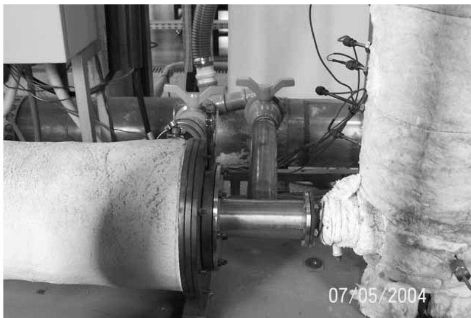
Figura 3.7 – Vista do aquecedor de ar elétrico acoplado ao reator de bancada. Observa-se também as duas válvulas de esfera para a seleção de ar quente ou frio para a operação do reator.
