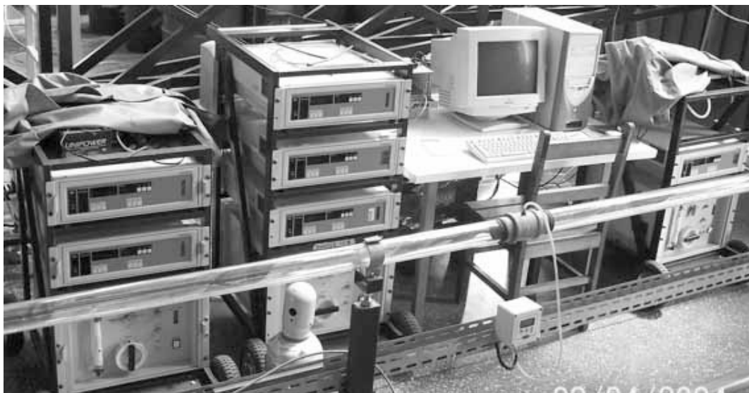
Figura 3.23 – Vista dos analisadores de gás e suas respectivas unidades de amostragem.
