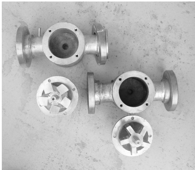
Figura 3.19 – Vista das válvulas rotativas desmontadas da planta piloto. As válvulas têm paletas de latão de espessuras diferentes: as paletas para carvão são menos espessas que as paletas para calcário.
