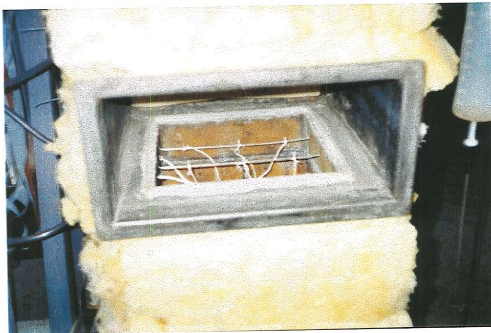
Figura 3.2.5- Posicionamento dos termopares na região inferior da estufa. Vista dos aros (3x) de suportação dos termopares, com os nove termopares isolados com fita de teflon.
